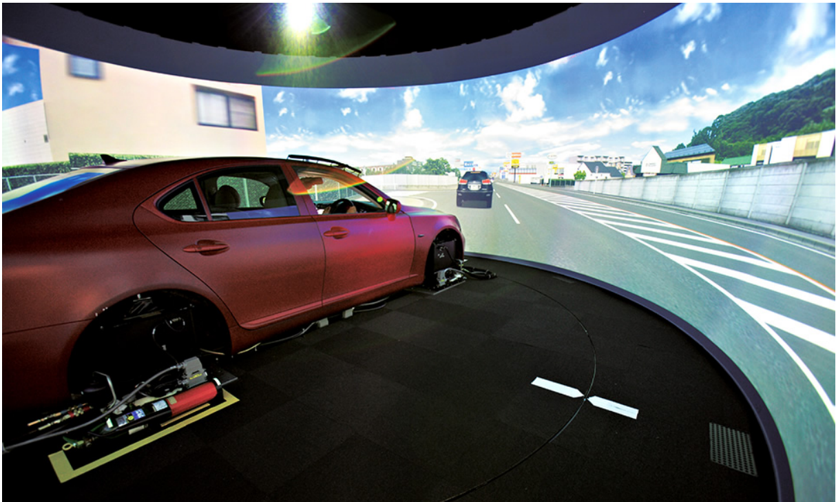
Lexus Driving Simulator on toteutettu katsojaa ympäröivällä projektiopinnalla.
