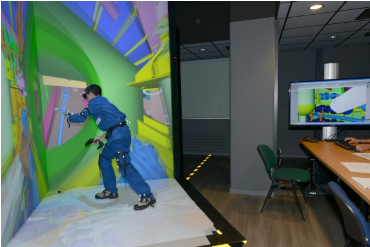
DCNS:n suunnittelija työskentelee laivan virtuaalimallin parissa
