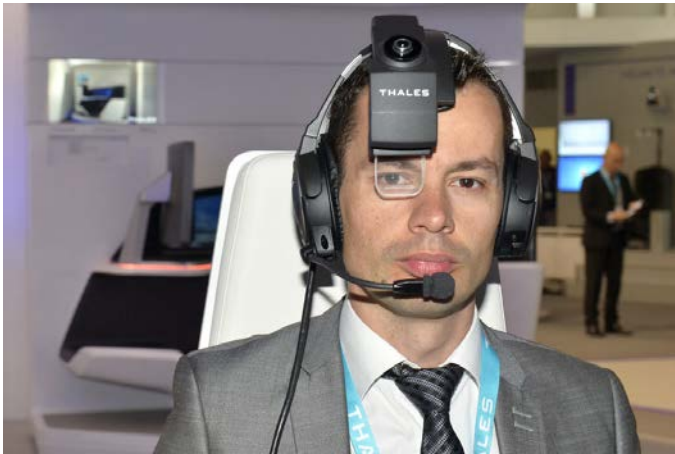
Thales siviilikäyttöön tarkoitettu lentäjän ylle puettava heijastusnäyttö
