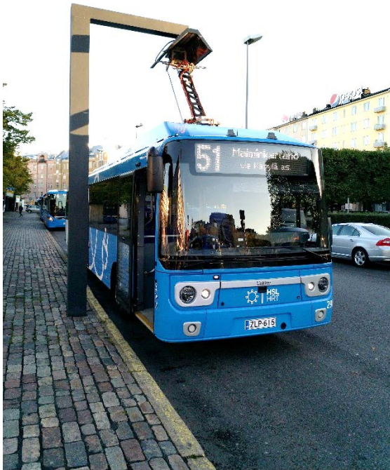
Kuva 5. Sähköbussin lataus bussin katolle asennetun pantografin avulla.
