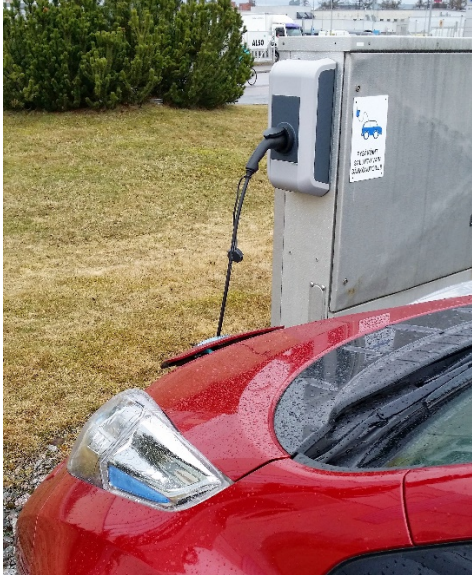
Kuva 2. Sähköauton peruslataus erillisellä latauslaitteella (lataustapa 3).
