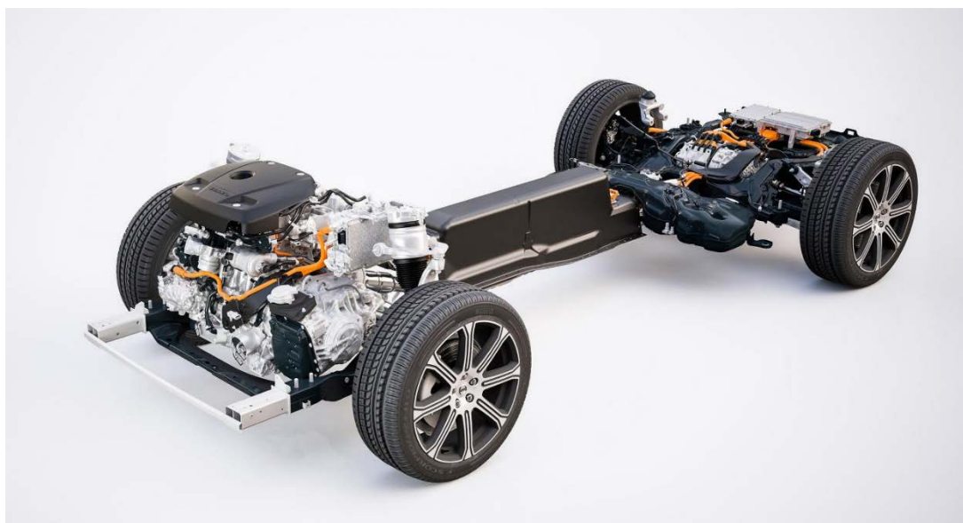
Kuva 7. Volvo XC60 ladattavan hybridin tekniikkaa (Kuva: Volvo Cars).
