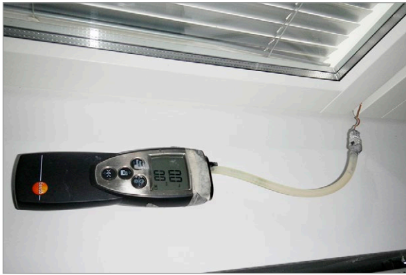
Kuva 3.23. Paine-eron lyhykestoinen mittaus (vasen kuva) ja pitkäaikaisseuranta mittalaitteella ja tallentavalla tiedonkeräimellä eli dataloggerilla (oikean puoleinen kuva). Paine-eron mittausputki on asennettu tuuletusikkunan kautta ulkovaipan ulkopuolelle. Kuvat: M. Pitkäranta, Vahanen Oy.
