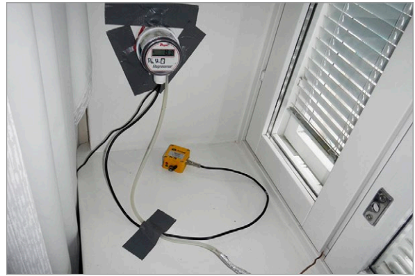
Kuva 3.23. Paine-eron lyhykestoinen mittaus (vasen kuva) ja pitkäaikaisseuranta mittalaitteella ja tallentavalla tiedonkeräimellä eli dataloggerilla (oikean puoleinen kuva). Paine-eron mittausputki on asennettu tuuletusikkunan kautta ulkovaipan ulkopuolelle. Kuvat: M. Pitkäranta, Vahanen Oy.
