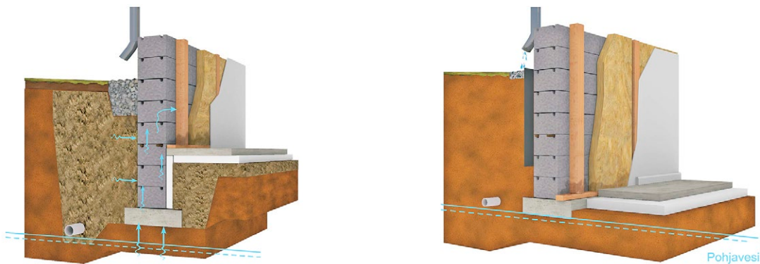
Kuva 7.76. Harkkomuurattuja maanvastaisia seinä. Sisäpuolinen lämmöneriste voi vaurioitua erityisesti alaosastaan maakosteuden vaikutuksesta. Kuva: Kosteus- ja hometalkoot, 2012.
