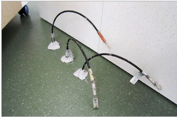
Kuva 3.7. Rakennekosteusmittaus betonirakenteesta. Eri syvyyksille asennetut mittapäät tasaantuvat välipohjarakenteen kosteusjakouman selvittämiseksi tehdystä porareikämittauspisteessä. Kuvat: K. Laine, Vahanen Oy.
