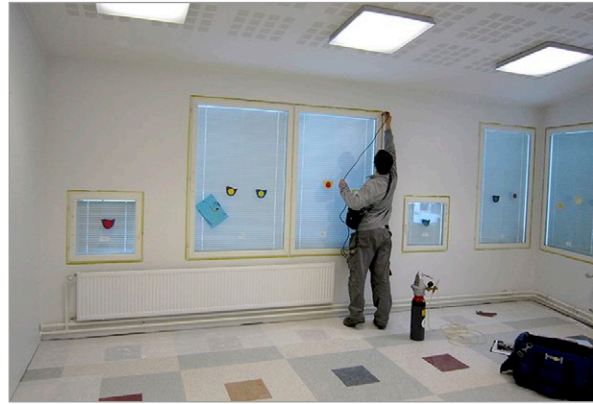
Kuva 3.13. Ilmavuotokohtien paikallistaminen merkkiainetekniikalla. Ulkoseinärakenteen sisälle on laskettu rakenteeseen poratusta reiästä merkkiainekaasua. Analysaattorilla kartoitetaan mahdolliset ilmavuotokohtat. Kuva: K. Laine, Vahanen Oy.
