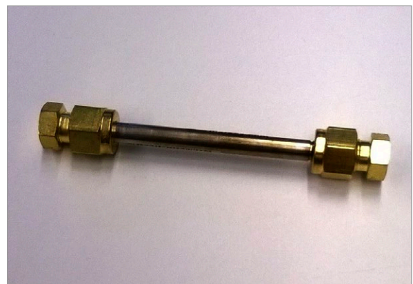
Kuva 3.16. Sisäilman VOC-näytteen keräys pumppuun kytketyllä adsorbenttikeräimellä. Oikeanpuoleisessa kuvassa päistä suljettu Tenax-TA -adsorbenttiputki. Kuvat: Mikrobioni Oy.
