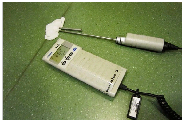
Kuva 3.8. Viiltomittaus muovimaton alle mattoliimaan kohdistuvan todellisen kosteusrasituksen selvittämiseksi. Oikeanpuoleisessa kuvassa toinen mittapää mittaa samanaikaisesti mittauskohdan sisäilman olosuhteita. Kuvat: K. Laine ja H. Tuovinen, Vahanen Oy.
