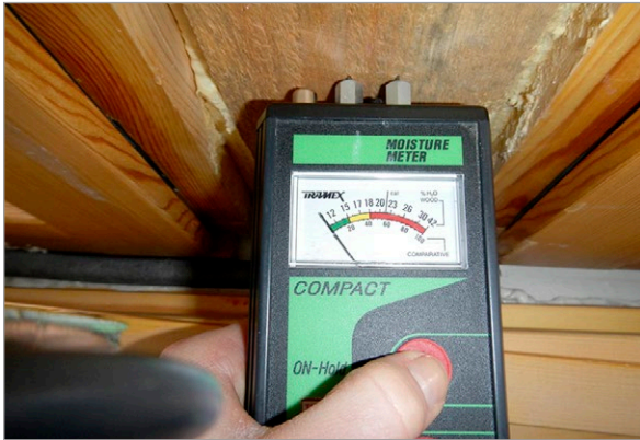
Kuva 3.10. Puun kosteusmittaus painoprosenteina voidaan tehdä helposti ns. piikkimittarilla. Vasemmalla olevassa kuvassa ikkunan karmipuun kosteuspitoisuus on mittarin mukaan alle 7 painoprosenttia, eli puu on kuivaa. Oikealla ulkoseinärakenteen koolauksen kosteuspitoisuus on noin 26 painoprosenttia, joten puu on selvästi märkää. Kuvat: M. Pitkäranta ja J. Sievola, Vahanen Oy.
