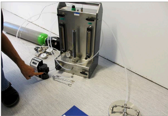
Kuva 3.17. Lattiapinnan emissiomittaus FLEC-menetelmällä. Vasemmassa kuvassa standardin SFS-EN ISO 16000-10 mukainen menetelmä ja oikeassa kuvassa ohjeen NT BUILD 484 mukainen menetelmä. Kuva: H. Tuovinen, Vahanen Oy
