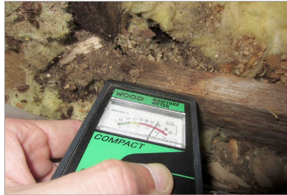
Kuva 3.10. Puun kosteusmittaus painoprosenteina voidaan tehdä helposti ns. piikkimittarilla. Vasemmalla olevassa kuvassa ikkunan karmipuun kosteuspitoisuus on mittarin mukaan alle 7 painoprosenttia, eli puu on kuivaa. Oikealla ulkoseinärakenteen koolauksen kosteuspitoisuus on noin 26 painoprosenttia, joten puu on selvästi märkää. Kuvat: M. Pitkäranta ja J. Sievola, Vahanen Oy.
