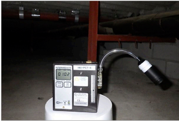
Kuva 3.19. Vasemmalla ilmanäytteenotto asbestianalyysiä varten. Näyte otettiin rakennuksen käyttötilojen ulkopuolisesta tilasta, jonka rakenteissa oli käytetty asbestipitoisia kuitusementtilevyjä. Oikean puoleisessa kuvassa krysotiiliasbestikimppu elektronimikroskooppikuvassa. Kuvat: T. Poutiainen ja J. Säntti, Vahanen Oy
