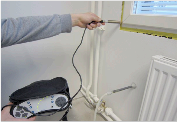
Kuva 3.13. Ilmavuotokohtien paikallistaminen merkkiainetekniikalla. Ulkoseinärakenteen sisälle on laskettu rakenteeseen poratusta reiästä merkkiainekaasua. Analysaattorilla kartoitetaan mahdolliset ilmavuotokohtat. Kuva: K. Laine, Vahanen Oy.
