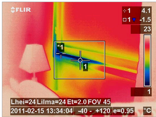
Kuva 3.11. Rakenteissa olevia ilmavuotokohtia voidaan paikantaa lämpökuvauksella. Ikkunarakenteen ja ulkoseinän vuotokohta havaittiin rakennuksen normaaleissa käyttöolosuhteissa, kuntotutkimuksen tukena lämpökameralla tehdyssä tarkastelussa. Lämpökuvauksista voidaan käyttää myös rakennuksen ulkopuolella, esimerkiksi lämmöneristyspuutteiden ja kosteuden toteamiseen (kuva 3.12). K. Laine, Vahanen Oy.
