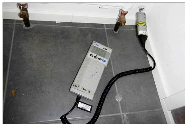
Kuva 3.9. Rakenteessa olevan eristetilan ilman suhteellisen kosteuden tutkiminen lyhytkestoisella mittauksella. Vasemman puoleisessa kuvassa alapohjalaatan alaisen löyhän hiekkatäytön kosteusmittaus laatan ja täytön rajapinnasta. Oikean puoleisessa kuvassa rankarakenteisen, tiiliverhoillun ulkoseinän eristetilan kosteuden mittaus seinän alaosasta. Ulkoseinän mittaus tehtiin lämpimänä vuodenaikana, jolloin sisäilman ja rakenteen välisen lämpötilaeron vaikutus mittaukseen oli vähäinen. Kuvat: M. Pitkäranta, Vahanen Oy.
