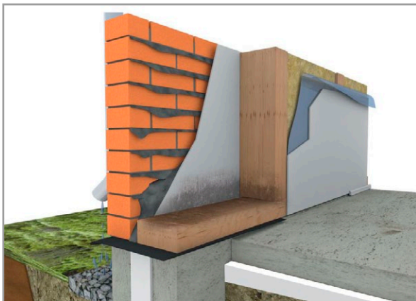
Kuva 7.17. Laastipurseet tukkivat tiiliverhoillun rankarakenteisen ulkoseinän tuuletusvälin. Kuva: Kosteus- ja hometalkoot, 2012.
