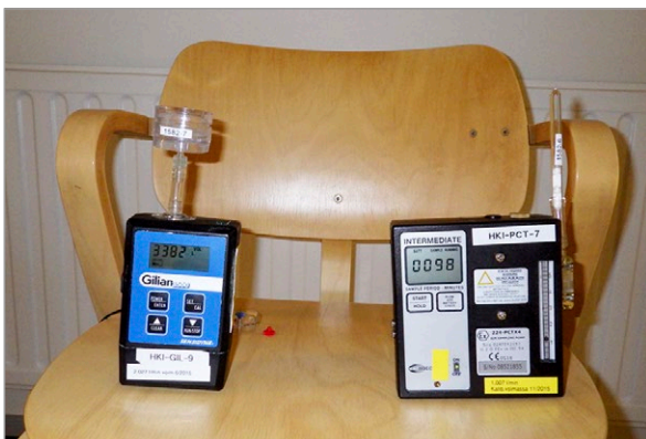
Kuva 3.20. Ilmanäytteenotto PAH-yhdisteanalyysiä varten. Kuvassa vasemmalla pumppuun liitetty hiukkaskeräin suodattimella ja oikealla pumppuun liitetty XAD-2-adsorbenttikeräinputki. Kuva: T. Poutiainen, Vahanen Oy
