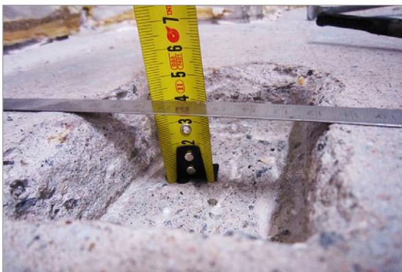
Kuva 3.6 Näytepalamittaus. Vasen kuva: betonimuruset irrotetaan valitulta mittaussyvyydeltä. Oikea kuva: irrotetut betonimuruset on suljettu kosteusmittapään kanssa koeputkeen tasaantumaan. Kuvat: K. Laine ja J. Komonen, Vahanen Oy.
