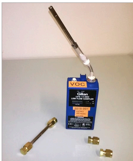
Kuva 3.16. Sisäilman VOC-näytteen keräys pumppuun kytketyllä adsorbenttikeräimellä. Oikeanpuoleisessa kuvassa päistä suljettu Tenax-TA -adsorbenttiputki. Kuvat: Mikrobioni Oy.
