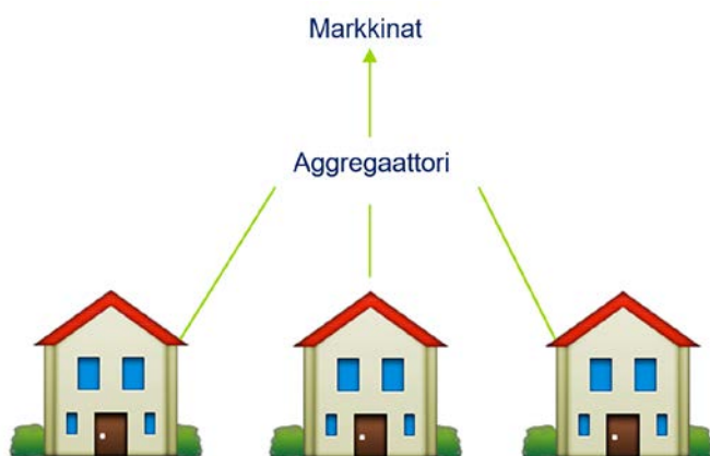
Kuva 2. Aggregaattori kokoaa asiakkaiden sähköntuotantoa, kulutusta ja varastoja isommaksi kokonaisuudeksi ja vie jouston markkinoille asiakkaiden puolesta.
