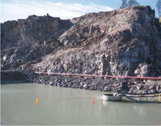
Kuva 8. Ottamisalueelta pois johdettava vesi pumpataan saostusaltaiden kautta maastoon.
