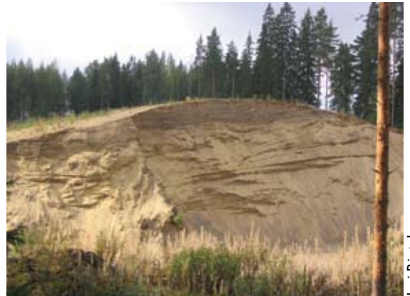
Kuva 18. Ottamisen aikana tulee huolehtia, ettei kaivualueelle muodostu sortumavaaraa aiheuttavia jyrkkiä luiskia.
