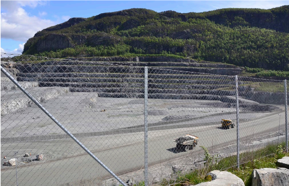
Kuva 10. Euroopan suurin kiviaineslouhos, Berakvam, kuvattuna yleisölle avoimelta näköalatasanteelta. Louhinnan rintauksen korkeus 15 m. Louhoksella esimurskaus, josta kuljetus hihnakuljettimilla rannan läheisyyteen jatkojalostukseen. Louhoksella irrotettiin 375 000 tonnia kiviainesta yhdellä kerralla elokuussa 2017. (kuva: Mika Räisänen)
