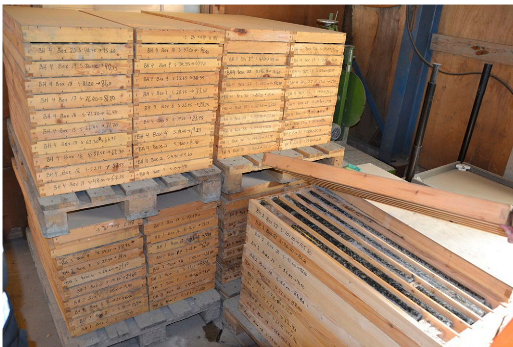
Kuva 16. Euroopan suurimman kiviaineskohteen laadun jatkuminen on varmistettu kattavalla kairausohjelmalla -50 metriä merenpinnan alapuolelle. (kuva: Mika Räisänen)
