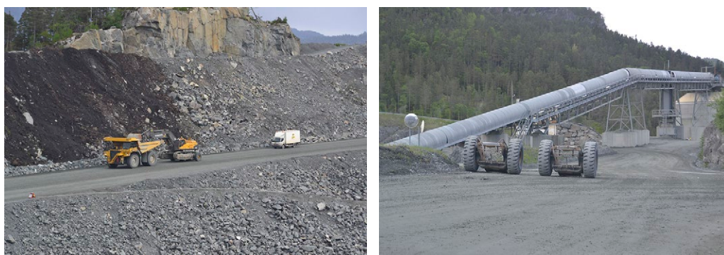
Kuva 19. Kaivinkoneen takaosa Sleipner yhtiön ”renkaiden” varassa ja etupää dumperin hinauksessa. (Kuvat: Mika Räisänen)
