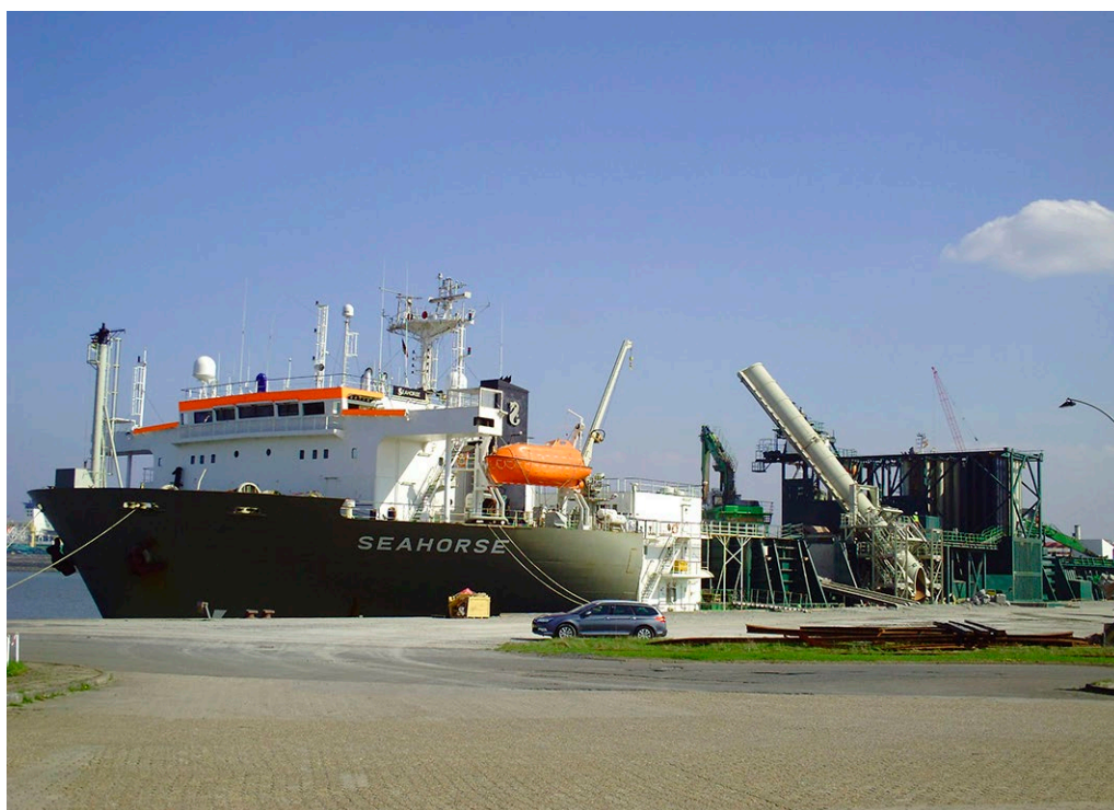
Kuva 8. Alankomaihin rekisteröidyn Seahorse-laivan kapasiteetti on 18 000 tn. Laivaa ja sen sisaralusta Sandpiperiä hyödynnettiin NordStream -kaasuputken kiviainestoimituksissa. Laivoissa materiaalin purkamisen tapahtuu hihnakuljettimilla purkuputken kautta asennuspaikkaan (kuva: Wikimedia commons).
