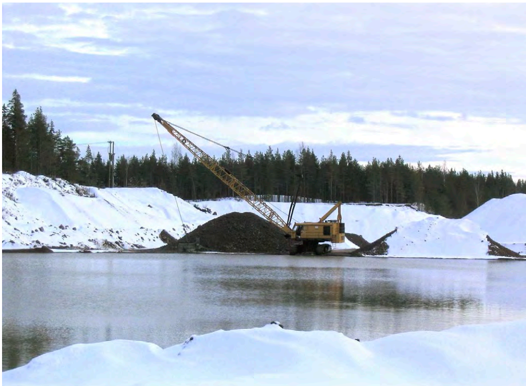
Bild 21. Grustagning under grundvattennivån tillåts i regel endast utanför grundvattenområden.
