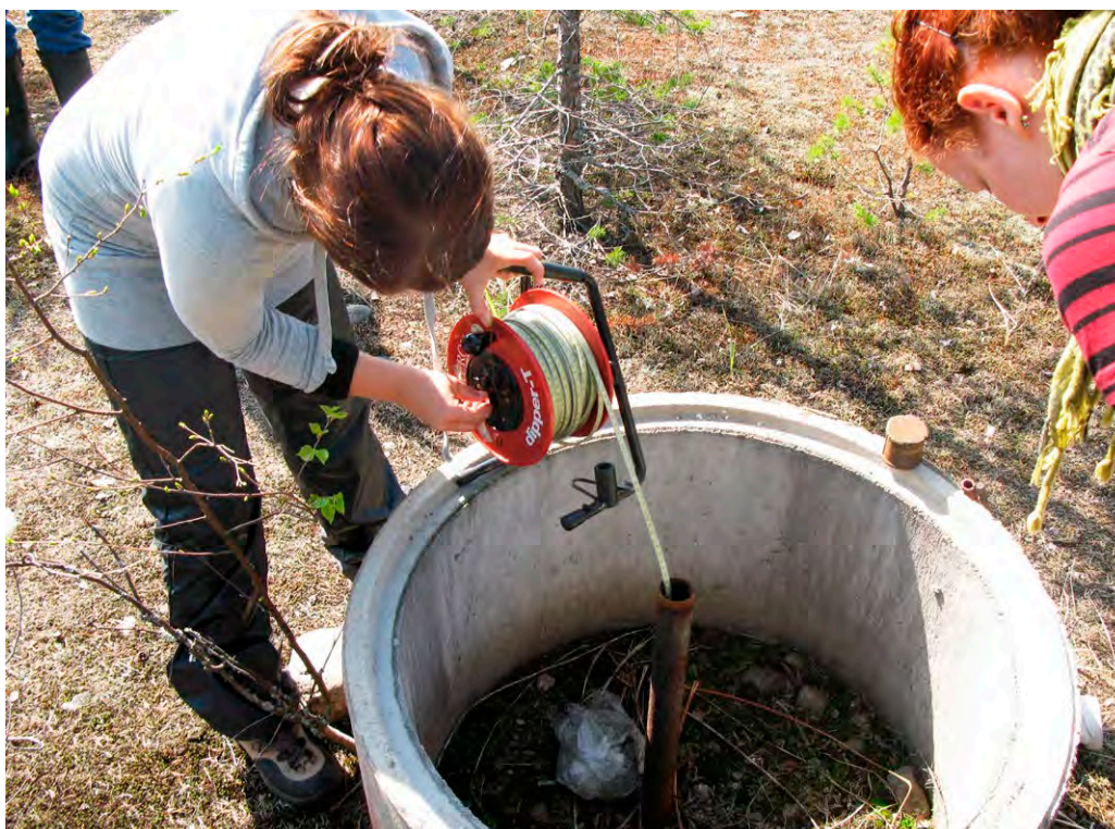
Bild 39. Övervakning av grundvattennivån omfattas ofta av tillståndsbestämmelserna för grustillstånd.
