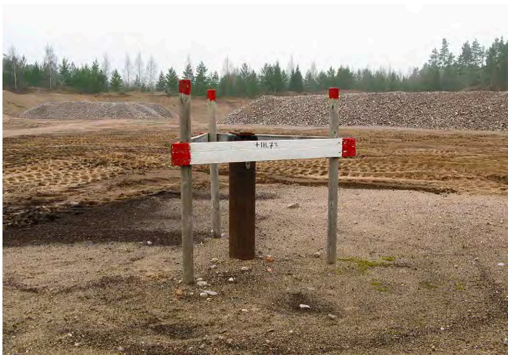
Bild 27. Höjdfixpunkter och nivåmarkeringar underlättar övervakningen av täktverksamheten.
