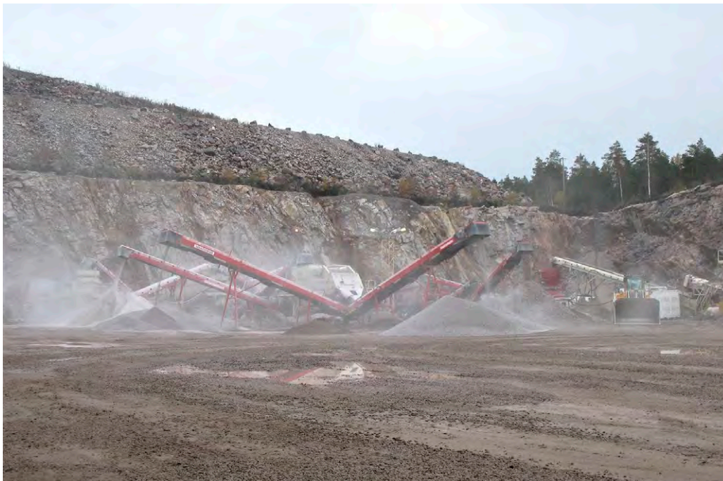
Bild 32. Dammolägenheterna från krosstensbrott kan reduceras genom till exempel valet av brytningsriktning och placeringen av upplagshögarna.
