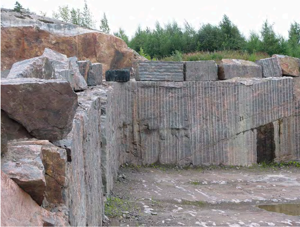
Bild 33. Naturstensbrotten finns oftast i områden med intakt berg, varför täktverksamheten sällan har betydande grundvattenpåverkan.
