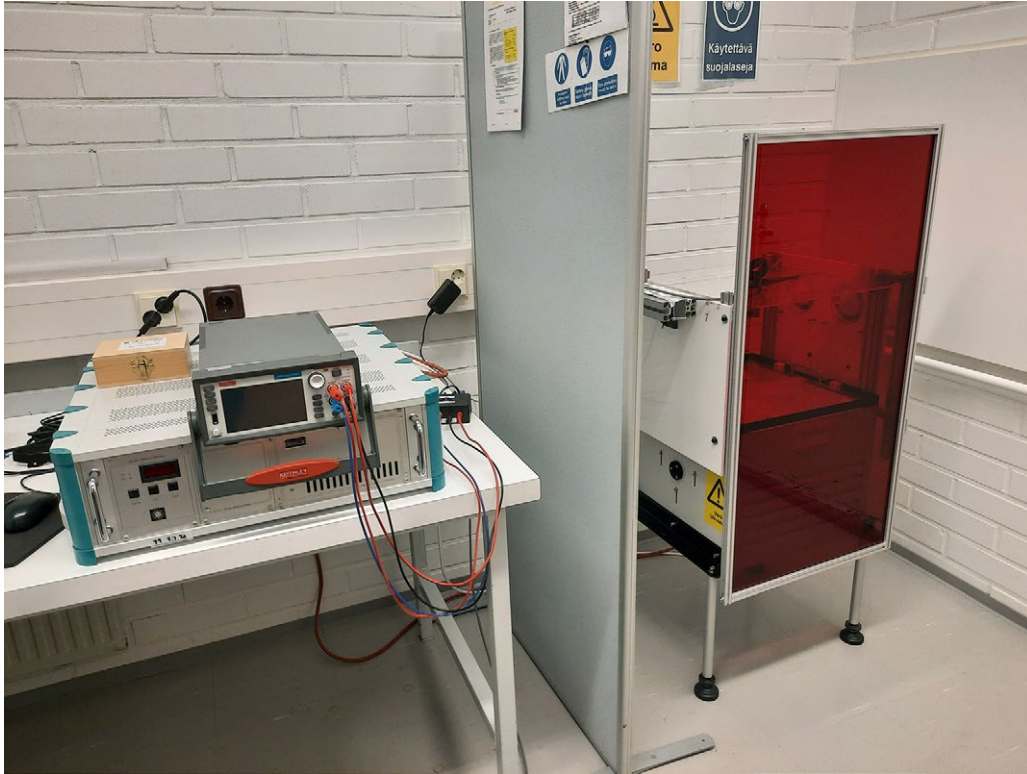
Kuva 2. AM1.5 keinoaurinkovalo mittauslaitteisto
