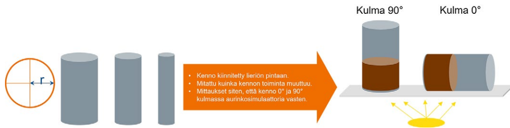
Kuva 3. Kennon toimivuuden määrittäminen eri taivutussäteillä ja suhteessa tulevan valon kulmaan.
