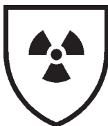
Bild 22.2. Piktogram som visar att ett skydd är avsett att skydda mot joniserande strålning.
