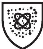
Bild 22.1. Piktogram som visar att ett skydd är avsett att skydda mot radioaktiv kontaminering.
