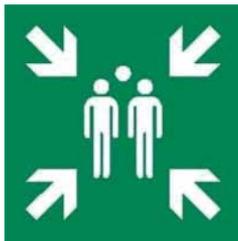
Kuva 13. Kokoontumispaikan merkki osoittaa rakennuksesta tai kiinteistöstä poistumisen jälkeisen turvallisen kokoontumispaikan sijainnin (SFS-EN ISO 7010)
