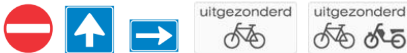
Kuva 11. Merkit C2 "kielletty ajosuunta" ja C3 ja C4 "yksisuuntainen tie", sekä lisäkilvet OB52 ja OB54 (uitgezonderd "poikkeus/paitsi").
