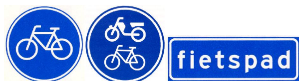
Kuva 22. Merkki G11 "pyörätie", merkki G12a "mopo- ja pyörätie" ja merkki G13 "ei-velvoittava pyörätie"
