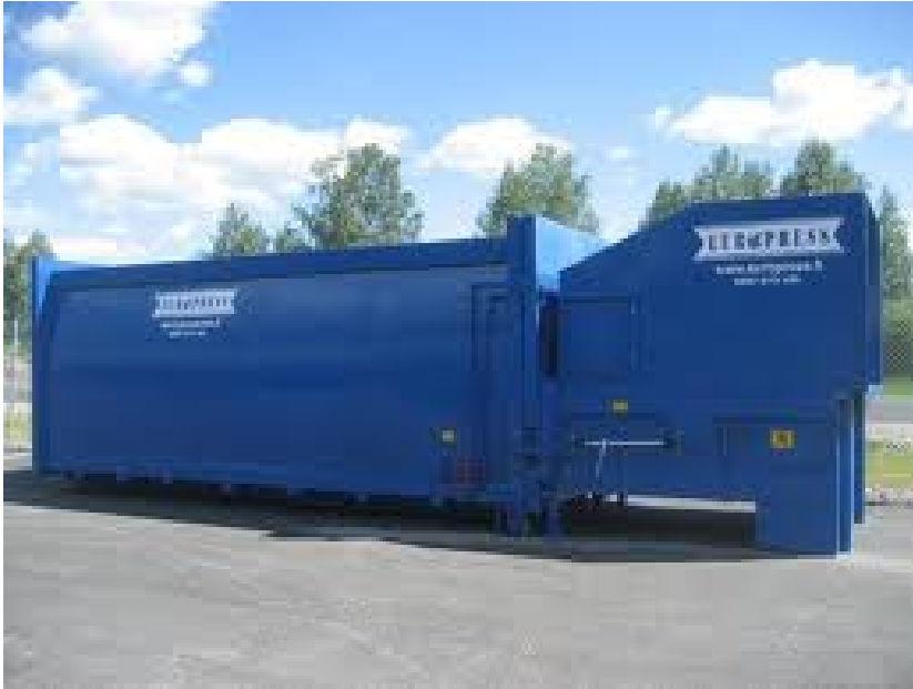
Kuva 11. Konttiin pakkaava hydraulipuristin (Lähde: Balerman-tuote-esite 2011).
