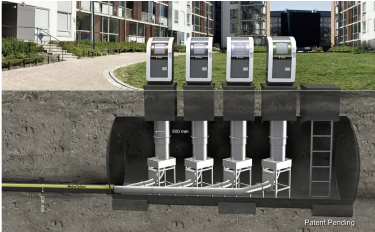
Kuva 9. Jätteen putkikeräyksen syöttöputket ja säiliöt Tampereen Vuoreksen alueella (Lähde: Pirkanmaan Jätehuolto Oy).
