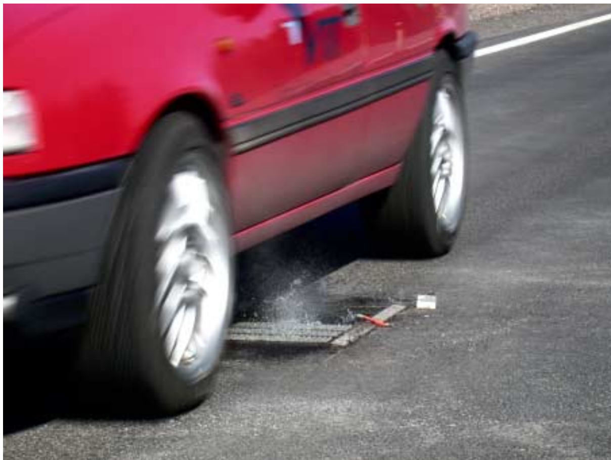
Kuva 4. Yliajokoe. Kuljettajan on osuttava leveilläkin renkailla jokaisella ylityskerralla kulutusalueelle. Koekappaleet pidetään märkinä kokeen ajan.
