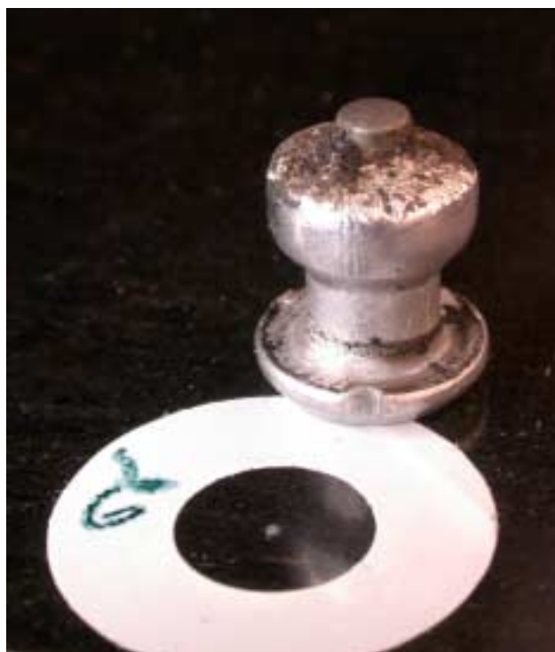
Kuva 3. Käytetty koenasta irrotettuna ja nastaiskujälki kiven pinnalla.
