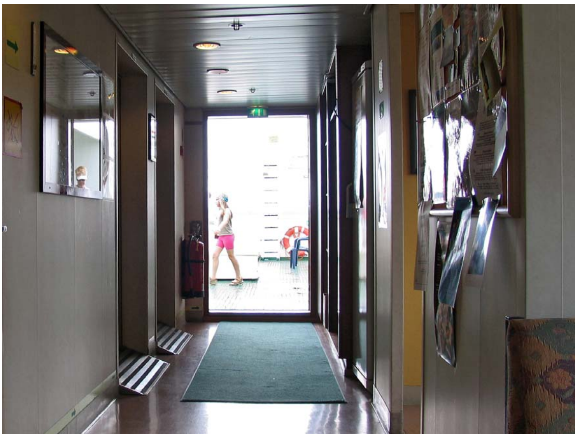
Bild 10. Även små åtgärder kan vara avgörande. Vid toalettdörrarna på M/S Viggen finns ramper. Likadana behövs vid utgångarna.
