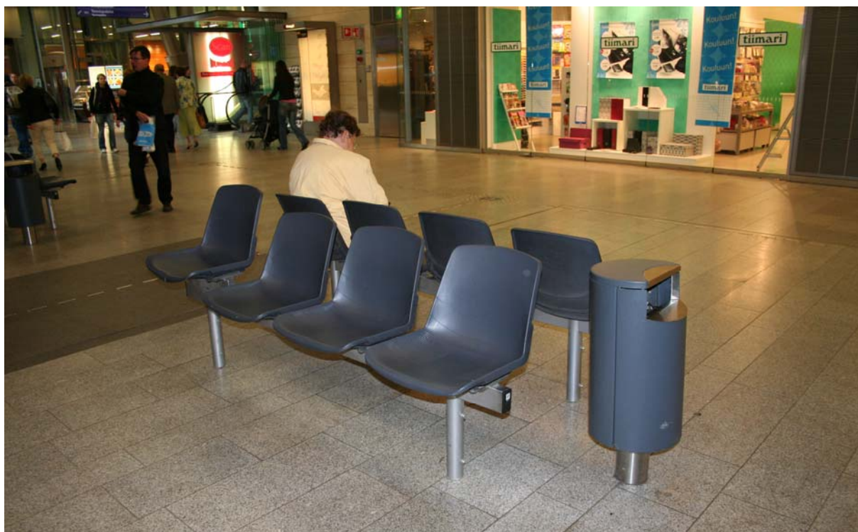
Kuva 20. Materiaalit vaikuttavat kalusteiden laatuvaikutelmaan mm. käytöstä johtuvan kulumisen kautta ja sen sopivuudesta korkeatasoiseen ympäristökokonaisuuteen. Kampin paikallisliikenteen terminaalin esteettömyystarpeet on huomioitu kahdella istuinkorkeudella. Istuinten kuopat ovat muovisia, mikä ei kestä hyvin kulutusta.
