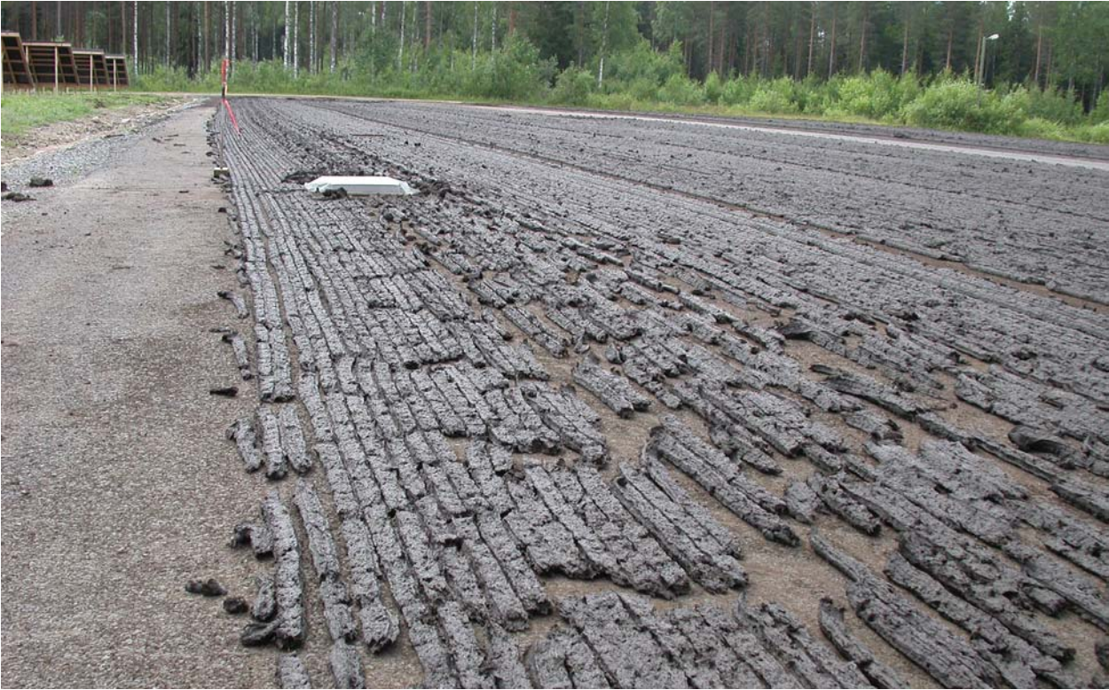
Uudella turvetuotantomenetelmällä korjattua polttoturvetta kuivatuskentällä. Kuivatuksessa hyödynnetään aurinkoenergiaa (Kuva: Sakari Sarkkola).
