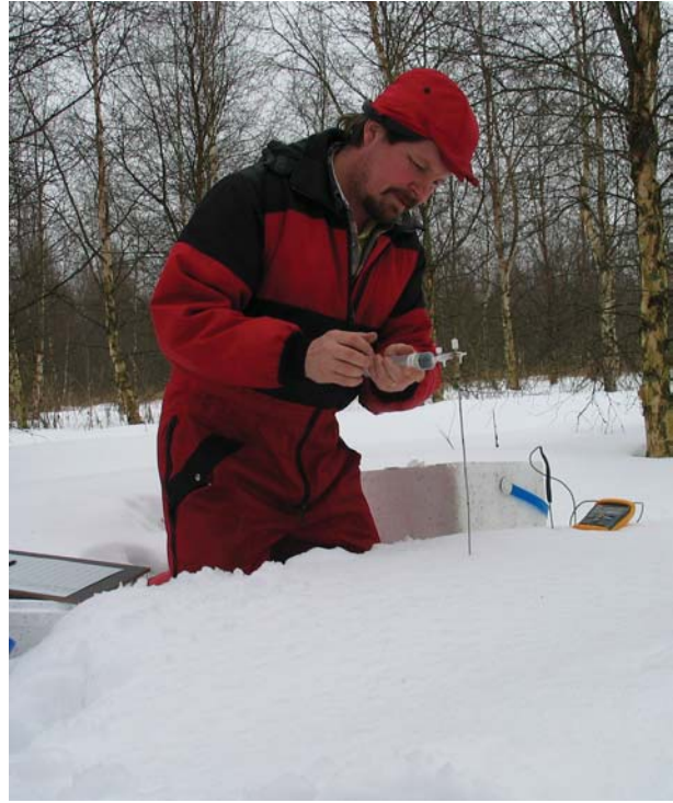
Lumigradienttimenetelmällä tehtävää kaasunäytteenottoa istutetussa koivikossa entisellä suopellolla (Kuva: Jyrki Hytönen).
