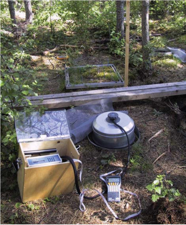
Maahengityksen mittauslaitteistoa metsitetyllä suopellolla (Kuva: Mikulas Cernota).
