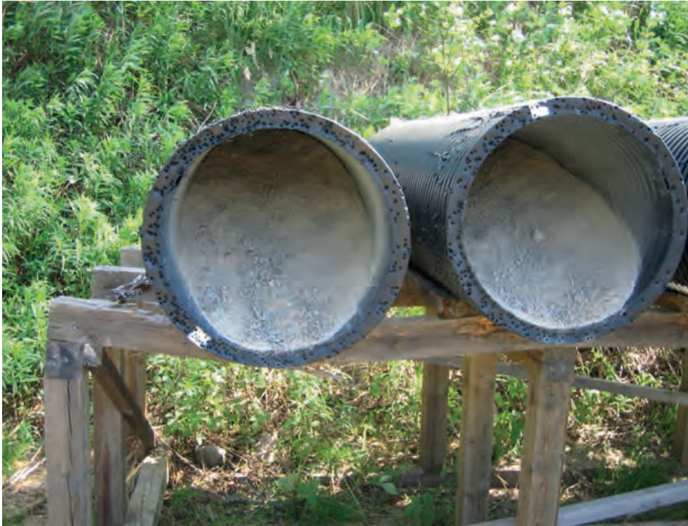
Kuva 5.10. Luotiloukut Koivujärven pistooliampumaradalla (kuva puolustusvoimat).
