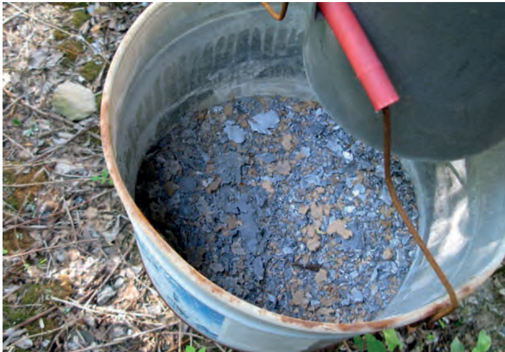
Kuva 5.8. Pirstaloituneita luoteja teräsluotiloukusta.
