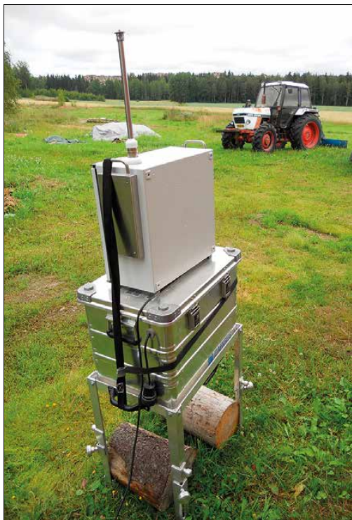
Kuva 25. Grimmhiukkasmassamonitori. Kuva: Sara Piutunen (a). Osiris-nefelometri, jolla mitataan partikkeleita optisesti. Kuva: Marjo Sairanen (b).
