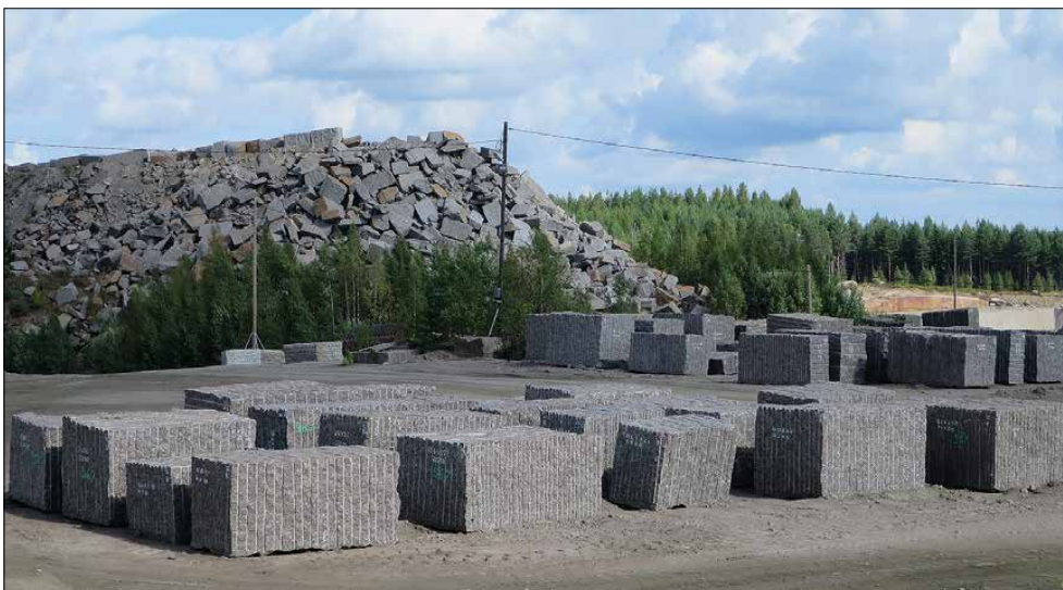
Kuva 6. Graniittilouhimon tuote on määrämuotoinen ja -mittainen, laatuluokiteltu kiviblokki. Kiviblokit varastoidaan omalle varastoalueelleen louhimolla (etualalla). Taustalla sivukiviä. Kuva: Olavi Selonen.
