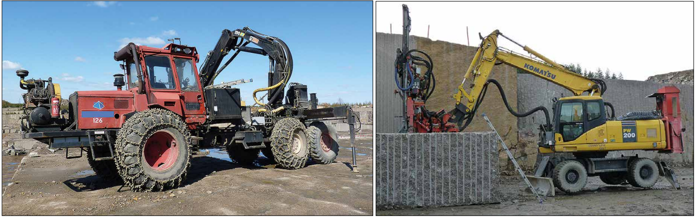
Kuva 12. Metsätyökonealustainen (a) ja kaivinkonealustainen (b) porayksikkö. Kuvat: Jani Kankare.
