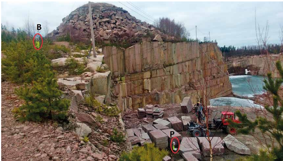
Kuva 28. Pölymittauslaitteistot pölylähteen (poran) läheisyydessä samalla tasolla (P) sekä seuraavalla louhintatasolla rintauksen päällä (B) myötätuulessa Kuva: Marjo Sairanen.
