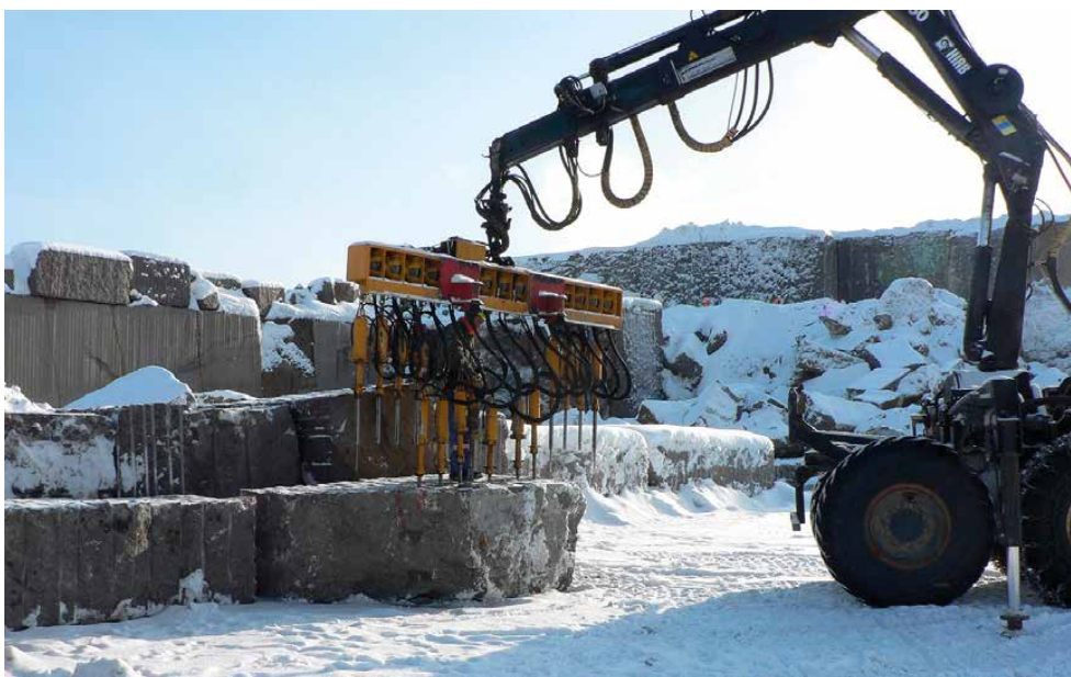
Kuva 24. Kiviainehion halkaisu kiilaamalla. Kiiloja asennetaan porareikiin. Kuva: Marjo Sairanen.
