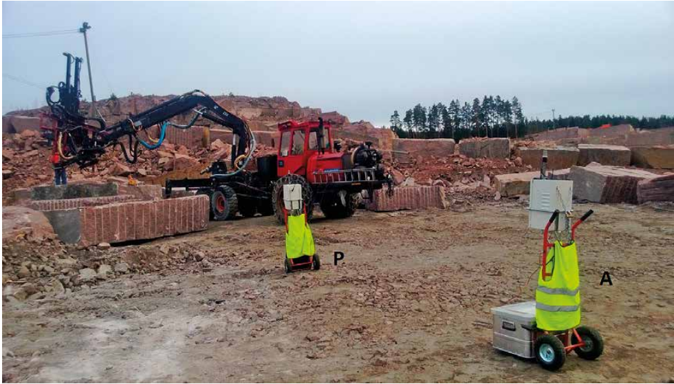
Kuva 27. Pölymittauslaitteistot poran kanssa samassa tasossa myötätuulessa eri etäisyyksillä. Kuva: Marjo Sairanen.
