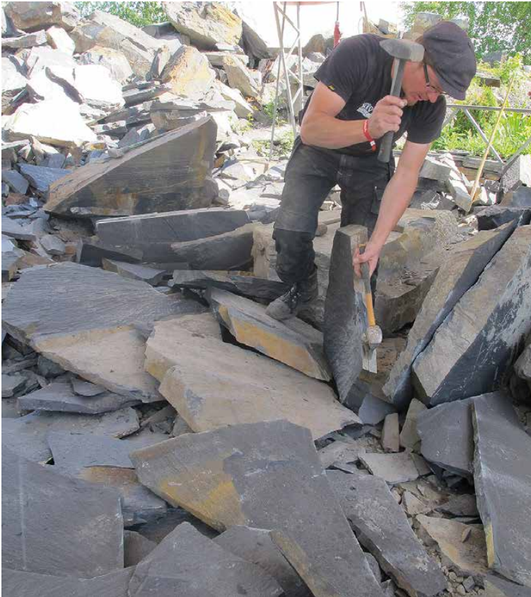
Kuva 8. Liuskekivillä on taipumus lohjeta laatoiksi. Liuskekivilaattoja valmistetaan käsityönä lohkomalla. Kuva: Seppo Leinonen.
