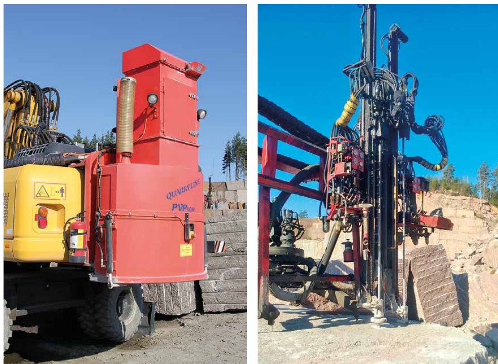
Kuva 23. Pölynkeräysyksikkö poralaitteessa. Kuva: Maria Palin (a). Porausta pölynkeräimellä varustetulla poralaitteella. Toinen poratanko on juuri nostettu ylös porareiästä, toinen vielä poraa. Kuva: Marjo Sairanen (b).
