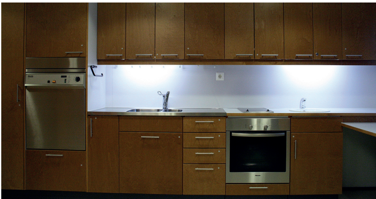
Kuva 44. Valokuvassa näkyy ryhmäkodin keittiön astianpesukoneen oikea sijoitus ja työtasoalalais-tuksen sijoitus siten, että siitä saadaan tasainen ja häikäisemätön valo.
