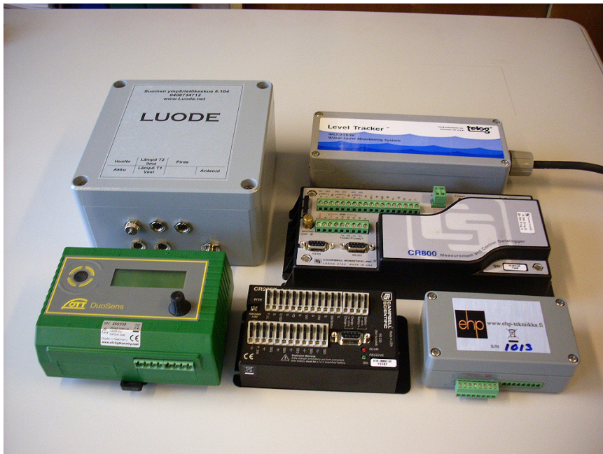
Kuva 4. Erilaisia tiedonkeräimiä: Alarivi vasemmalta oikealle: OTT-Duosens, Campbell-CR200, ehp-teknikka, keskellä Campbell-CR800, ylärivissä Luode, ja Telog-WL-2109e (Kuva: Risto Mäkinen, SYKE).
