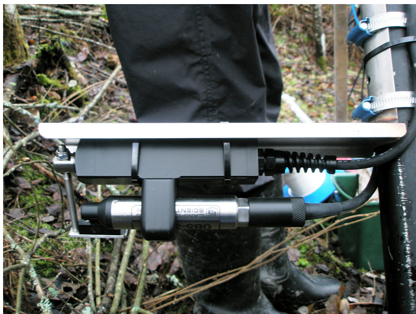
Kuva 1. OBS-3+ -sameusanturi harjapesurilla (Kuva: Lippo Sundberg, MTT).
