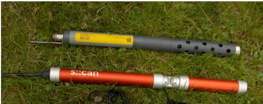
Kuva 3. YSI-sameusanturi (ylempi) ja S::can-spektrometriananturi (alempi) (Kuva: Mikko Kiirikki, Luode Consulting Oy).
