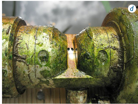
Kuva 15. a) Eliöitä linssissä, b) Biologista kasvustoa anturissa, c) Kasveja ja likaa anturissa, d) Biologista kasvustoa anturin rungossa. (Kuvat: Lippo Sundberg, MTT.)
