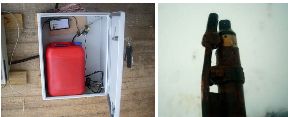
Kuva 2. Anturin vesipesurin ohjauskaappi (vas.) sekä vesipesurilla varustettu anturi (oik.) (Kuvat: Risto Mäkinen, SYKE).
