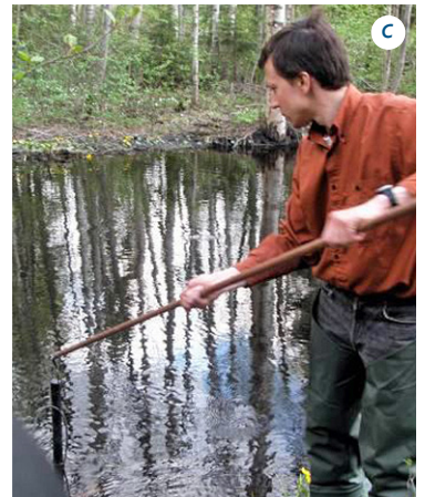
Kuva 10. Sameusanturin tolppa-asennus a) Pohjaan kiinnitetty tolppa on merkitty, jotta joessa liikkuvien on helppo huomata se, b) Mittausasema on asennettu rannalle puupaaluun, c) anturi voidaan nostaa ylös myös rannalta käsin (Kuvat: Lippo Sundberg, MTT).
