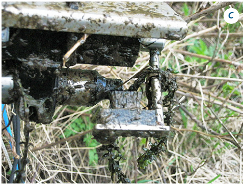
Kuva 15. a) Eliöitä linssissä, b) Biologista kasvustoa anturissa, c) Kasveja ja likaa anturissa, d) Biologista kasvustoa anturin rungossa. (Kuvat: Lippo Sundberg, MTT.)
