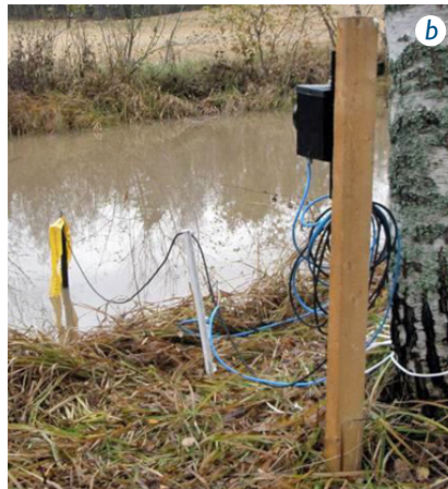
Kuva 10. Sameusanturin tolppa-asennus a) Pohjaan kiinnitetty tolppa on merkitty, jotta joessa liikkuvien on helppo huomata se, b) Mittausasema on asennettu rannalle puupaaluun, c) anturi voidaan nostaa ylös myös rannalta käsin (Kuvat: Lippo Sundberg, MTT).
