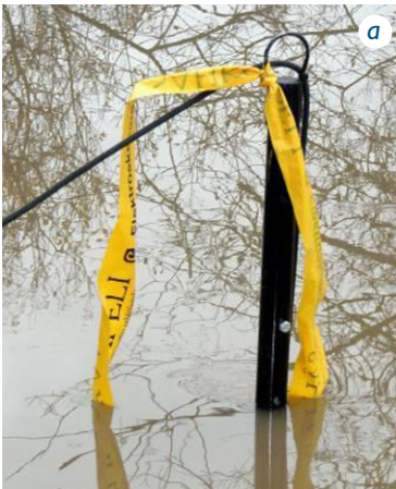
Kuva 10. Sameusanturin tolppa-asennus a) Pohjaan kiinnitetty tolppa on merkitty, jotta joessa liikkuvien on helppo huomata se, b) Mittausasema on asennettu rannalle puupaaluun, c) anturi voidaan nostaa ylös myös rannalta käsin (Kuvat: Lippo Sundberg, MTT).
