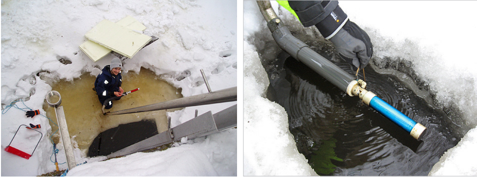
Kuva 13. S::can laitteen huoltoa talviolosuhteissa (Kuvat: Vas. Sirkka Tattari, SYKE, oik. Helmi Kotilainen, VAR-ELY).
