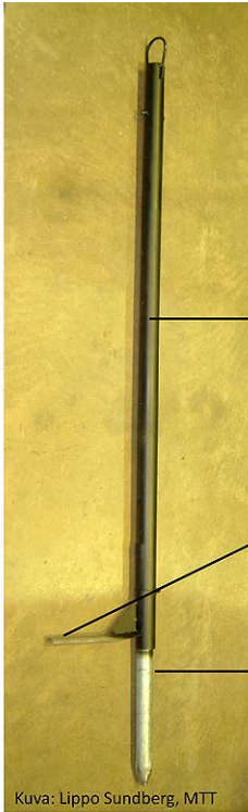
Kuva 9. Maasää-mittausverkostoa varten suunniteltu tolppa-asennuksen teline (Kuva: Lippo Sundberg, MTT).
