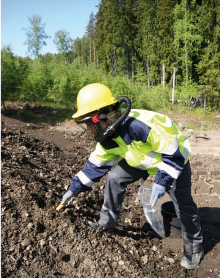
Kuva 3. Suojautumisen näytteenottotilanteessa, jos maaperässä on kiinteiden haitta-aineiden lisäksi mahdollisesti haihtuvia aineita. (Kuva: Heikki Kokkonen)
