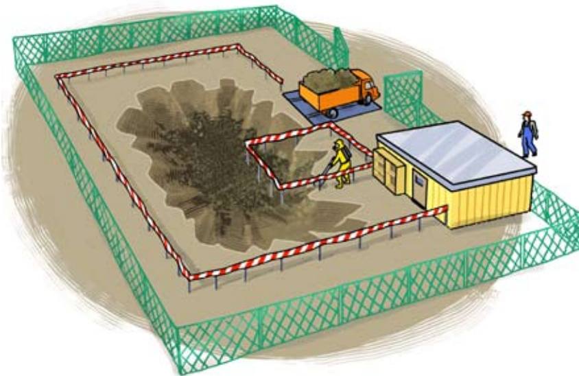
Kuva 19. Kunnostuskohteen jakaminen eri vyöhykkeisiin riskien laadun ja suuruuden perusteella (Marksanering... 2002). Kuva: Ingela Jondell
