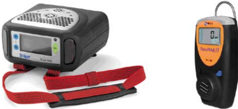
Kuva 8. Vasemmalla neljää ilmassa esiintyvää kaasua samanaikaisesti mittaava laite, oikealla yhtä kaasua mittaava laite. (Kuvat: Liitin Oy ja Senvec Oy)
