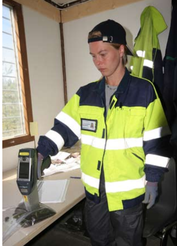
Kuva 5. Röntgenfluoresenssi (XRF)-laitteen kanssa työskenneltäessä on huomioitava säteilyturvallisuus. (Kuva: Heikki Kokkonen)
