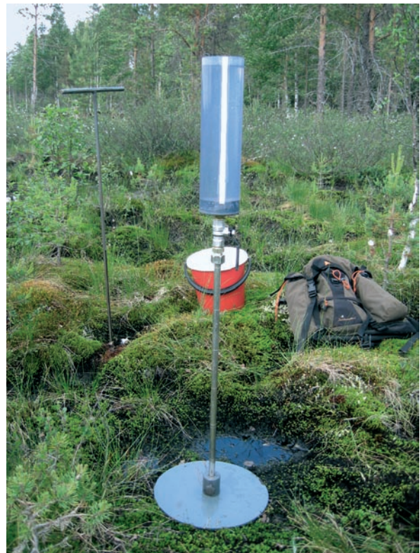
Kuva 2. Tutkimuksessa käytetyn pietsometrin kaaviokuva ja kuva. Kuva: Elina Juola.
