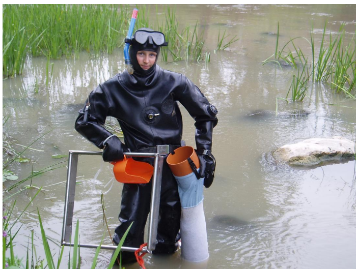
Kuva 8. Sukeltajan tutkimusvälineet: tutkimusruutu, keruupussi ja lapio, jolla pohjaa kaivetaan.
