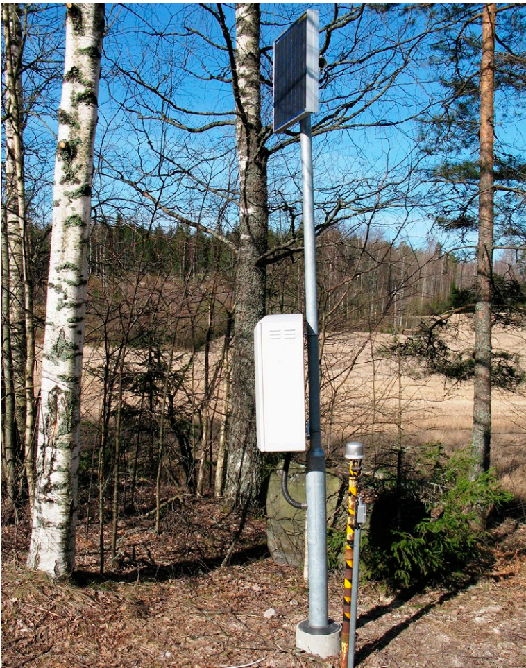
Kuva 16a ja 16b. Pohjaveden pinnan korkeuden mitttaustuloksia voidaan hyödyntää pohjaveden virtausolosuhteiden määrittämisessä: Mittaus voidaan tehdä joko manuaalisesti. Kuvat: Jari Rintala.
