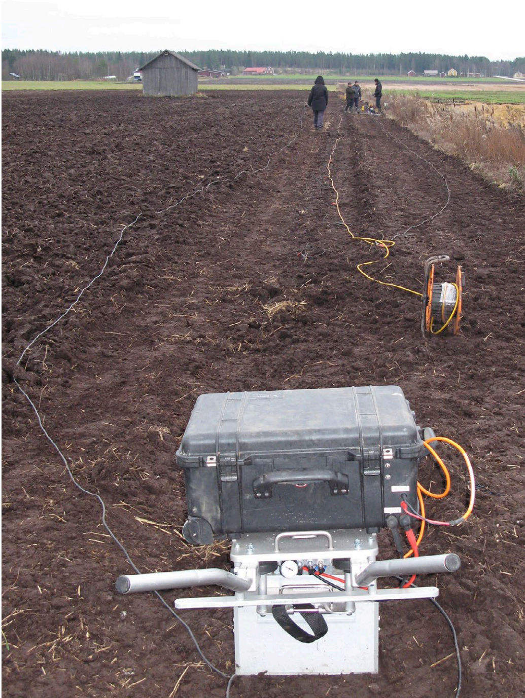
Kuva 6. Pohjanmaalla esiintyy syväpohjavesialueita, joiden rajaaminen on erittäin haasteellista. Tällaisia laajoja pohjavesimuodostumia on esimerkiksi Kurikassa ja Kauhajoella. Näiden muodostumien osalta on eräillä alueilla pystytty geofysikaalisiin tutkimuksiin osoittamaan savi- ja siltti-muodostumien alla sijaitsevan huomattavan antoisia ja hyödyntämiskelpoisia pohjavesivarantoja. Reflektioseismistä luotausta Kurikan Kuusistonloukolla, kuva Jari Rintala.
