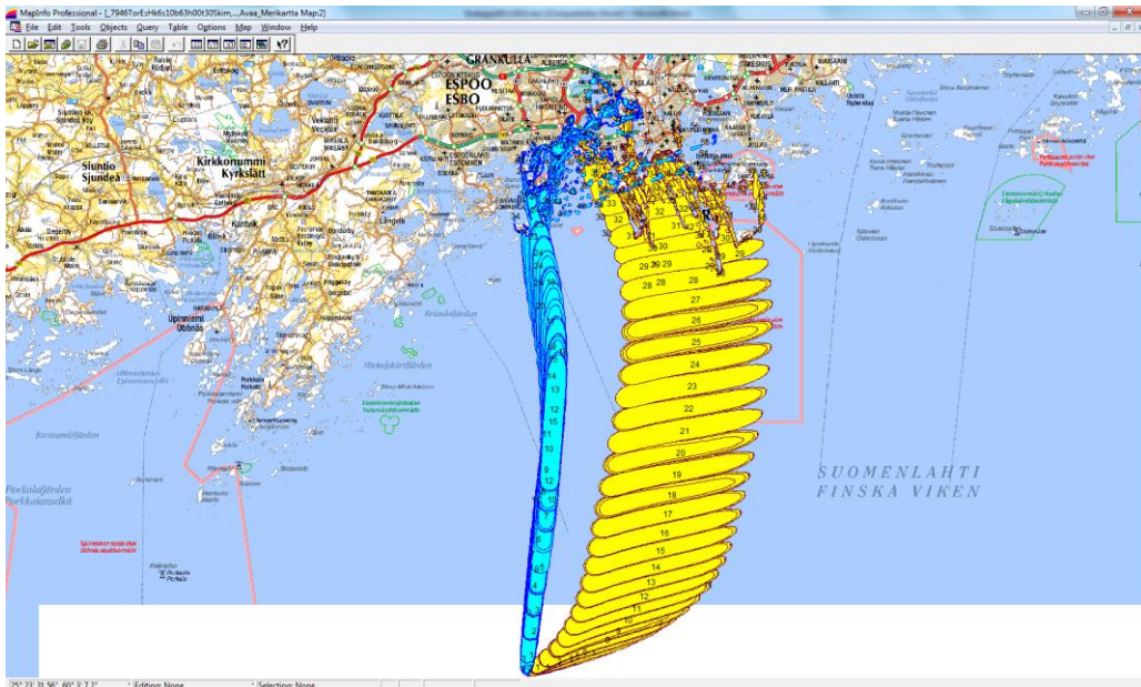
Kuva 13. SpillMod mallinnuksen tulos kahdelle suuröljyvahinkoesimerkille, joissa molemmissa kuuden tunnin kuluessa kaikkiaan 30000 tonnia raakaöljyä vuotaa +4 asteiseen meriveteen. Liitteessä on selostettu tätä laskentaa tarkemmin.
