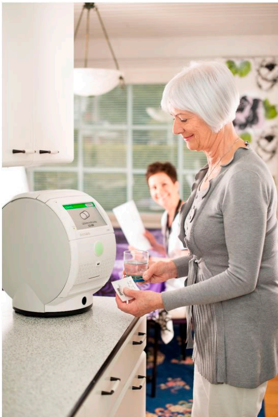
Kuva 15. Lääkeannostelurobotti toiminnassa. (Kuva: Evondos Oy)
