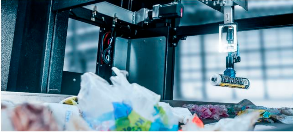
Kuva 16. Materiaalien lajittelija toiminnassa. (Kuva: FastPicker, ZenRobotics)
