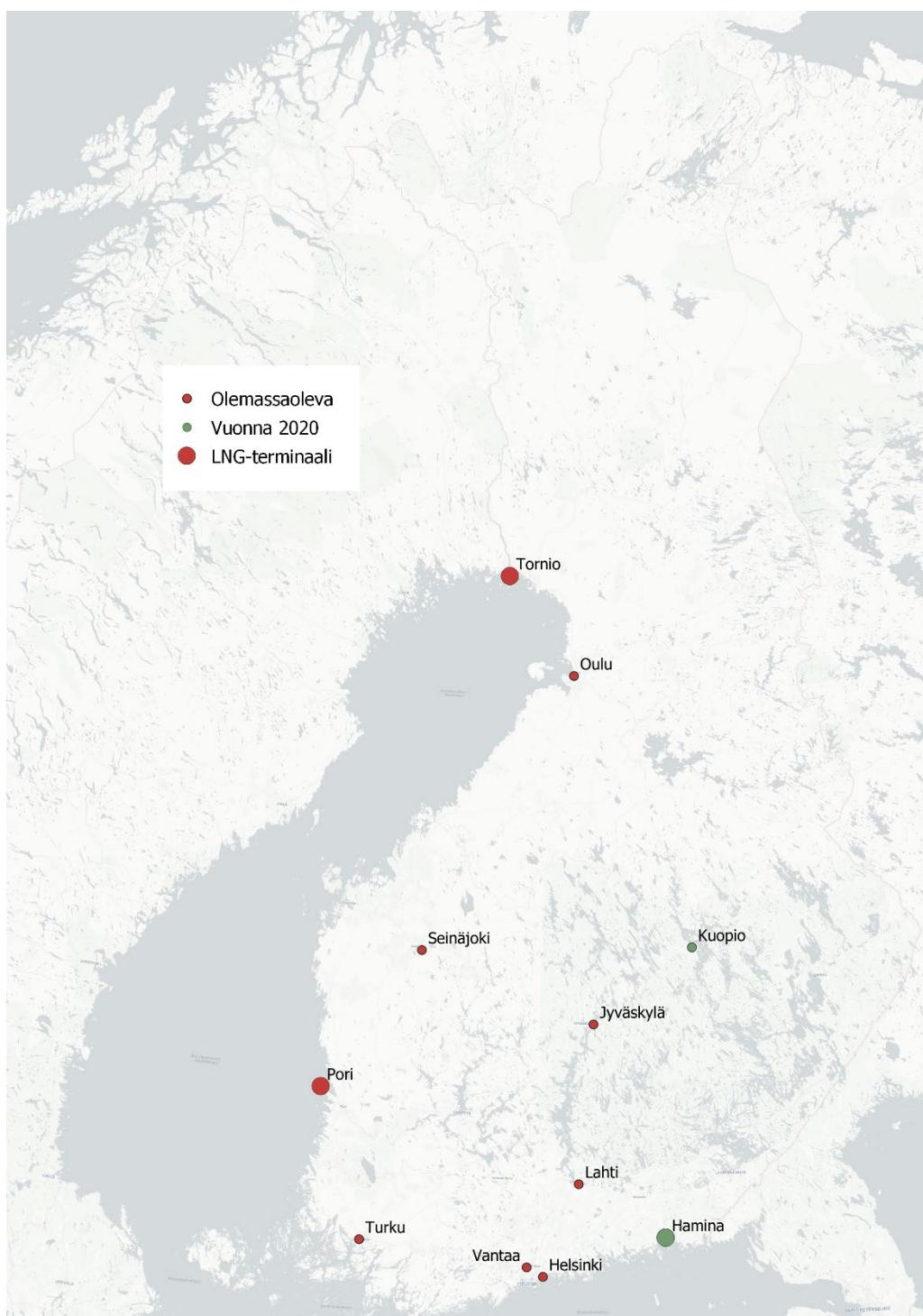
Kuva 14: Nesteytetyn maa- (ja bio-) kaasun tankkausasemat ja LNG-terminaalit (Tornio, Pori, Hamina, näissä alusten bunkrausmahdollisuus, ei LNG-tankkausmahdollisuutta) Suomessa syksyllä 2019
