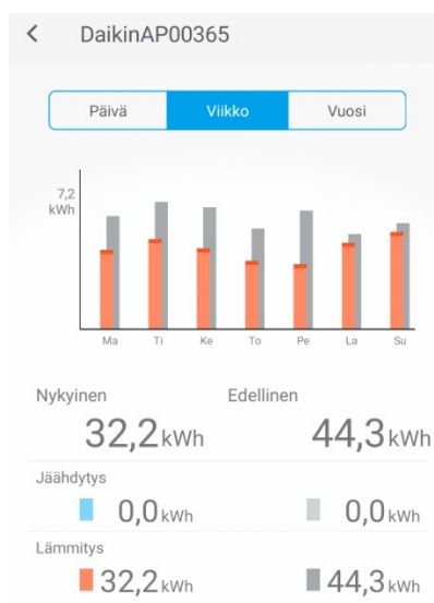
Kuva 12. Yhden esimerkkiviikon kulutus verrattuna edellisen viikon vakioämpötila-asetukseen (kuvakaappaus Daikin online-controller älypuhelinsovelluksesta, lauantain ja sunnuntain asetukset samat vertailuviikolla).
