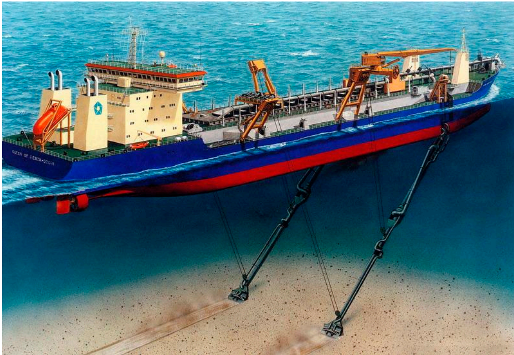
Kuva 13. Liikkuvalta alukselta imetään hiekkaa kahden imupään avulla laivan ruumaan. Suomessa hiekkamuodostumien pinnalla on tyypillisesti karkeampaa ainesta, joka voi tukkia imupäät, minkä takia liikkuvaa imuruoppausta ei aina voida suorittaa.
