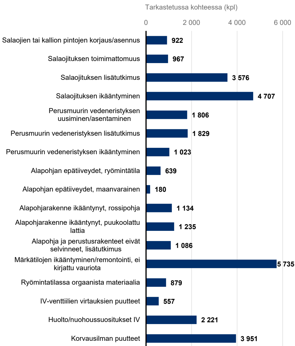
Kuva 10. Tarkastuksilla tehdyt muut havainnot.
