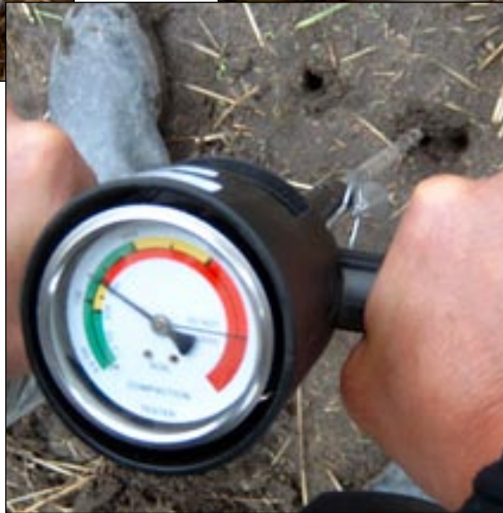
Kuva 14. Pintamaan vedenjohtavuuden mittaus onnistuu yksinkertaisilla välineillä, mutta maahengityksen mittaus vaatii jo erikoisvälineitä. Penetrometrillä voidaan tutkia maan tiiviyyttä.
