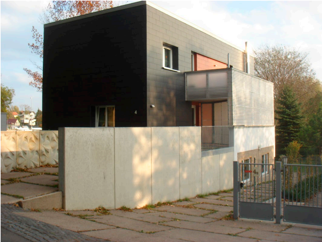
Kuva 7. Puretuista betonielementeistä rakennettu paritalo, Müllhausen, Saksa, 2007. Kuva Jukka Lahdensivu.
