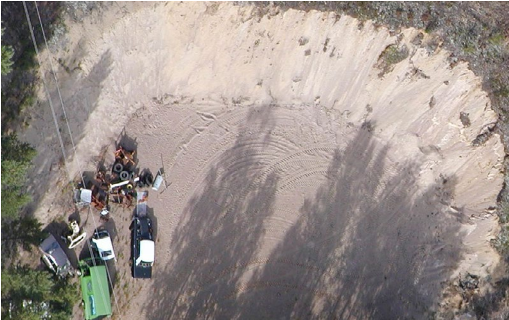
Kuva 46. Ottamisen päätyttyä ottamisalue tulee siistiä romuista sekä huolehtia kiviainesten käsittelyyn liittyvien laitteistojen poiskuljettamisesta.
