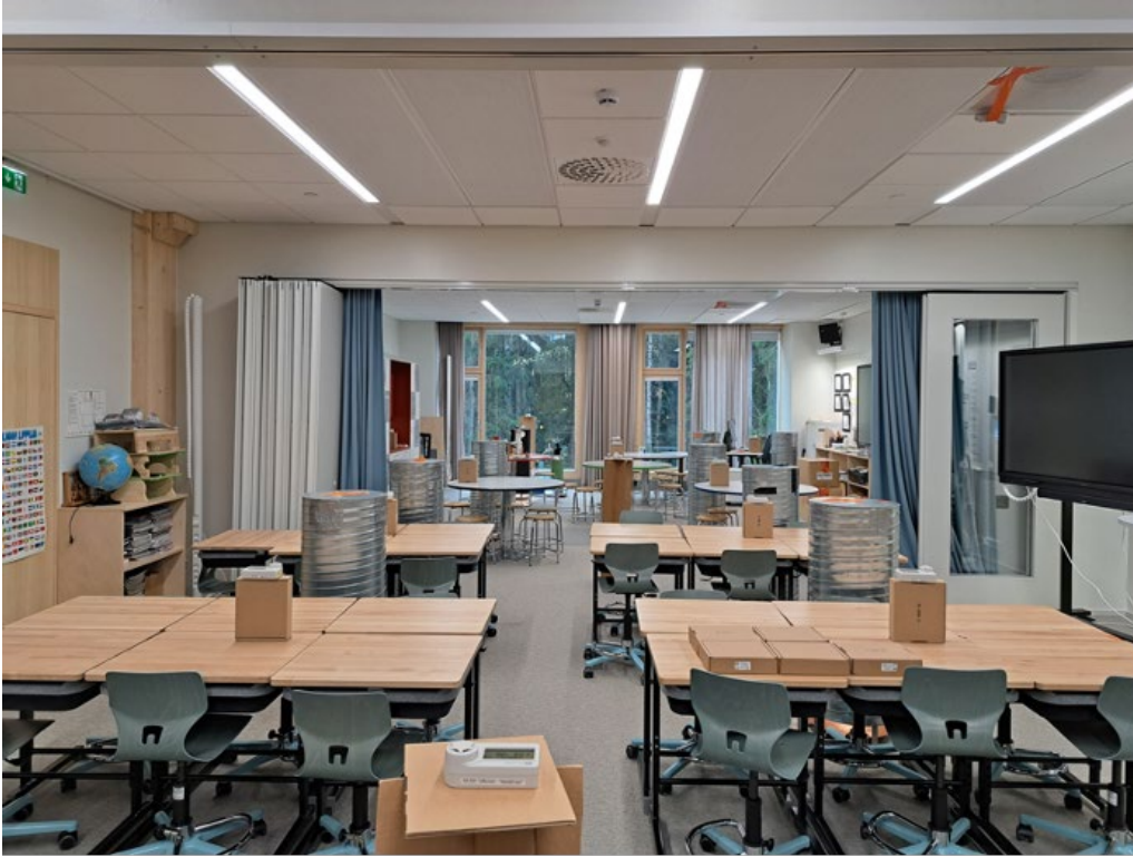
Kuva 6.3 Ilmanvaihdon tehokkuuden mittaus merkkiainemenetelmällä opetustilassa ja avotoimistossa. Kuvista näkyy loggereita, jotka osoittavat mittauspisteet, ja henkilöitä kuvaavia ilmanvaihtokanavasta valmistettuja lämmitettyjä nukkeja.
