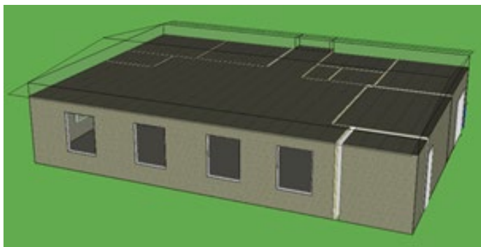
Kuva 3.4. 60-luvun pientalon IDA ICE simulointimalli.
