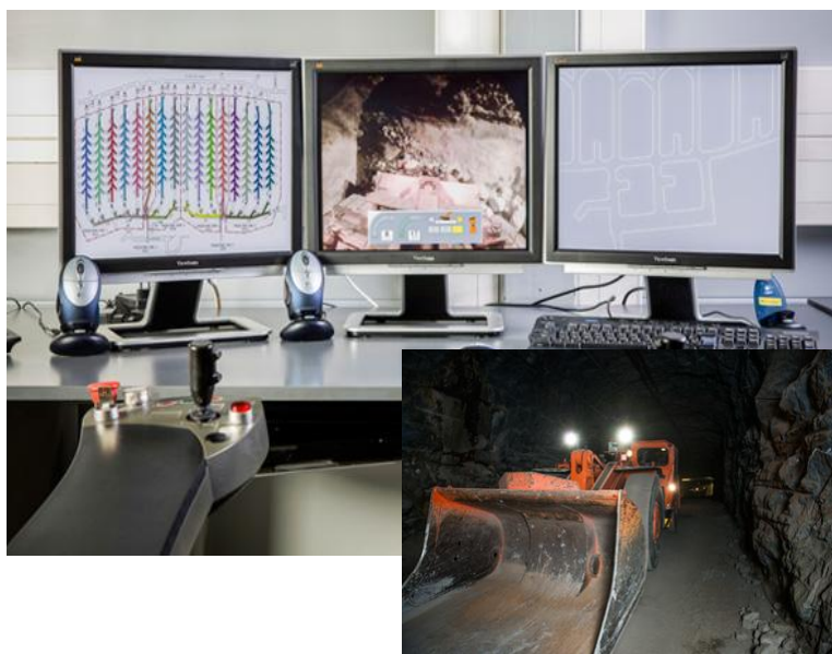
Kuva 10. Sandvikin AutoMine-teleoperointiasema ja itsenäinen lastari (LHD) (Lähde: Sandvik Mining ja Mikko Ovaska).
