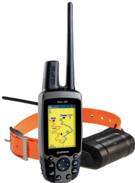
Kuva 4. Seurantajärjestelmä, joka välittää paikkatiedon koiran kaulapannan laitteesta modifioituun navigaattoriin. Navigaattoria voidaan käyttää myös ilman seuranta-järjestelmää. Vasemmalla oleva lyhyempi antenni on GPS-vastaanottoon. Oikealla oleva pidempi antenni ottaa vastaan radioviestit suoraan koiran pannaan lähettimestä ilman tukiasemia tai GSM-järjestelmää. (Garmin)
