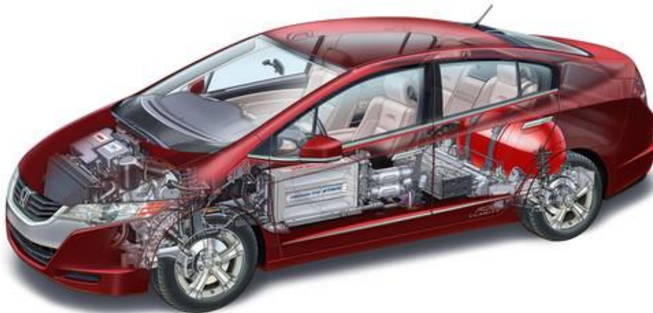
Kuva 4.9. Honda Clarity polttokennoauton rakenne. Kuvan 4.3 sähkömoottori-alennusvaihte-tasauspyörästä –yhdistelmä on myös Honda Clarity –autosta. (Honda 2011)
