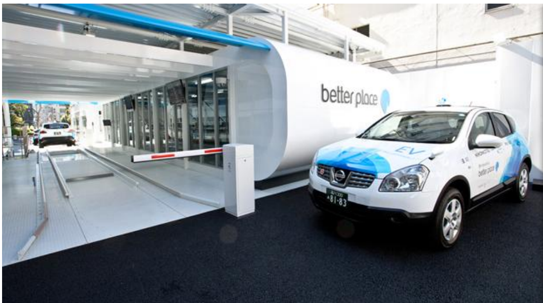
Kuva 5.7. Akkujen vaihtoasema. (Better Place 2010)
