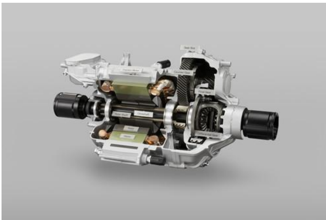
Kuva 4.3. Etuvetoisen auton sähkömoottori-alennusvaihte-tasauspyörästä -yhdistelmä. (Honda 2011)
