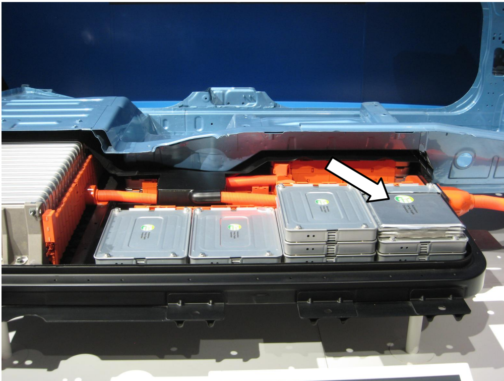
Kuva 5.5. Nissan Leafin akkuratkaisu. Oikealla reunassa oleva moduuli on leikattu auki paljastaen pussimaiset kennot. Kuva Nils-Olof Nylund.
