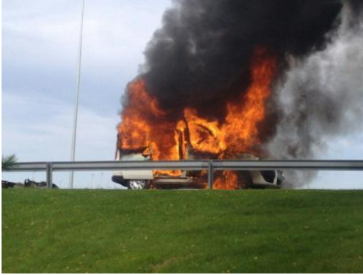
Kuva 19.3. Sähköauto palaa Länsiväylällä 10.9.2009. Autossa oli kobolttioksidiaakut, joita turvallisuussyistä ei enää käytetä (kts. 5.3.2.). Esim. litium-rautafosfaattiakut ovat turvallinen vaihtoehto. Kuva Ilta-Sanomat/Juha Jauhiainen.
