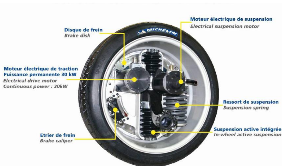
Kuva 4.5. Michelinin pyörämoottoriratkaisu. Sähkötönnöörin teho on 30 kW. (Michelin 2008)
