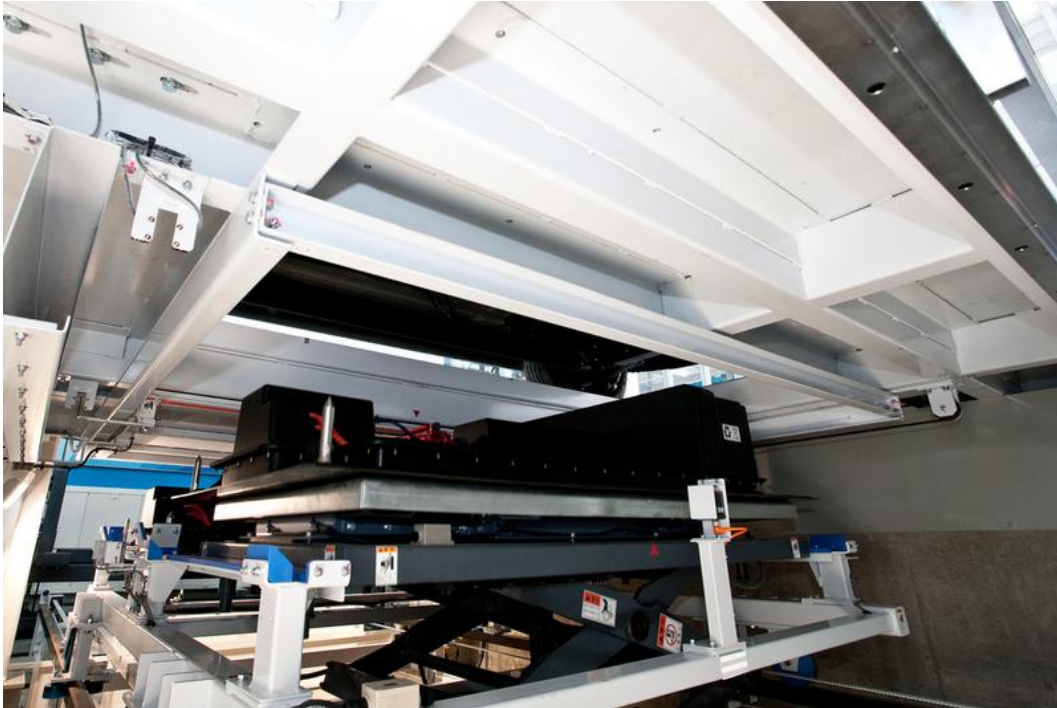
Kuva 5.8. Akkupaketti ja auton alla toimiva akkupaketin nostojärjestelmä. (Green Car Congress 2010)
