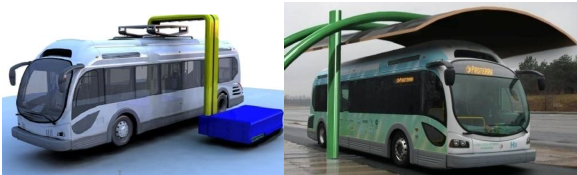
Kuva 6.11. Bussin pikalataus virtakiskojärjestelmän avulla. (Karbowksi & Nuchterlein 2010)
