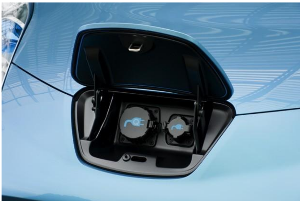
Kuva 6.4. Nissan Leafin keulassa sijaitsevat latausliittimet. Isompi on pikalatausta varten. (Nissan USA 2011)
