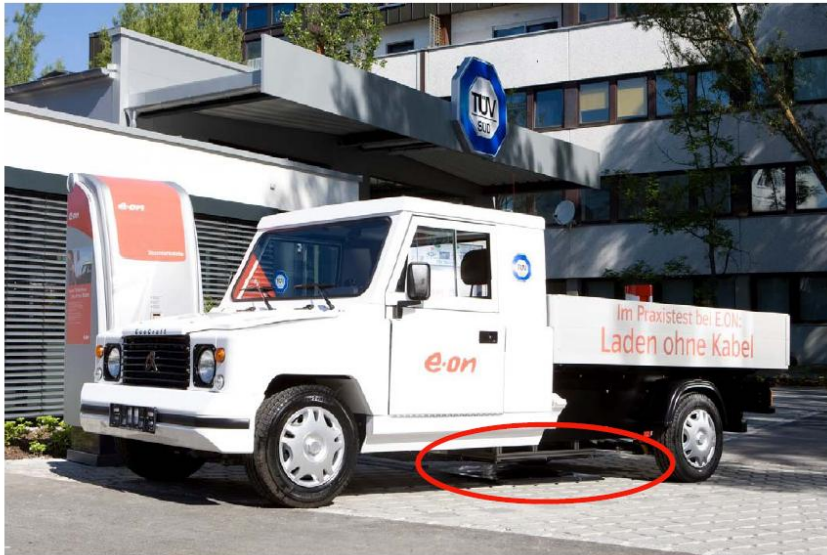
Kuva 6.10. Sähköauton induktiivinen lataus. (Weltin 2010)
