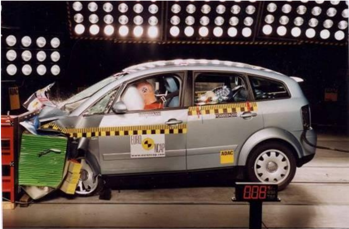
Kuva 3. Törmäystesitit ovat ohjanneet merkittäväällä tavalla autojen koriturvallisuutta (EuroNCAP).
