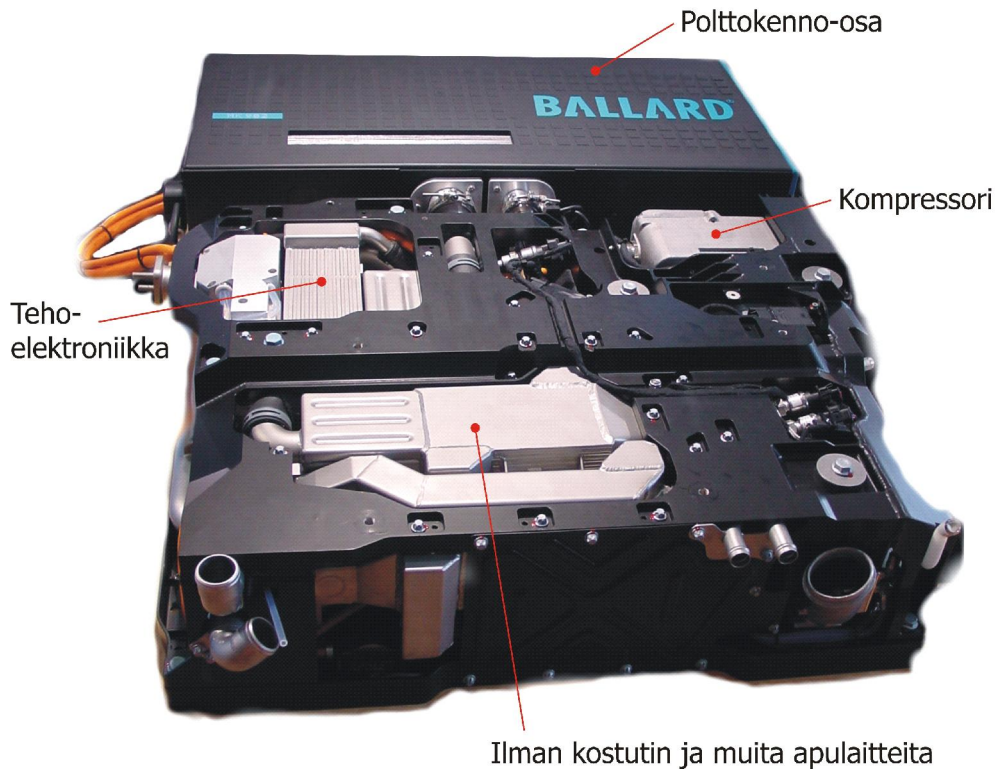
Kuva 14. Autokäyttöön sovitettu polttokenno apulaitteineen (Ballard).
