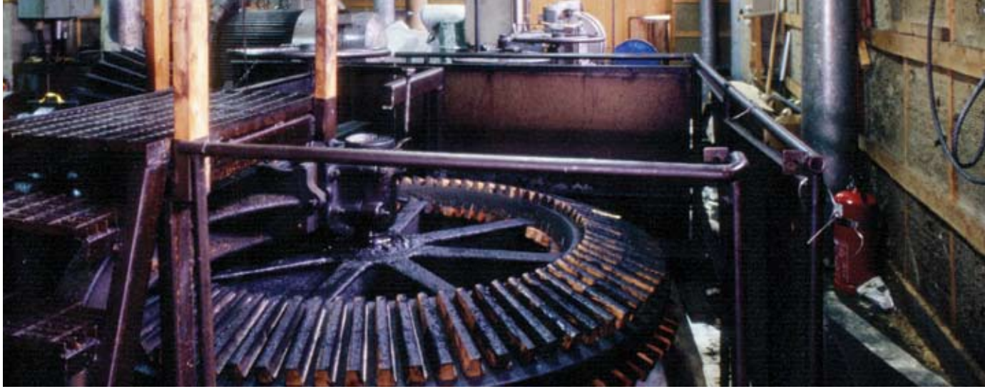
Kuva 9: Tehtaan 1980-luvulla rakennettu turbiinihuone sisältä. Etualalla näkyy vesiturbiinin puinen hammasratas. Matti Huuhka 1998, Museokuva, MV.
