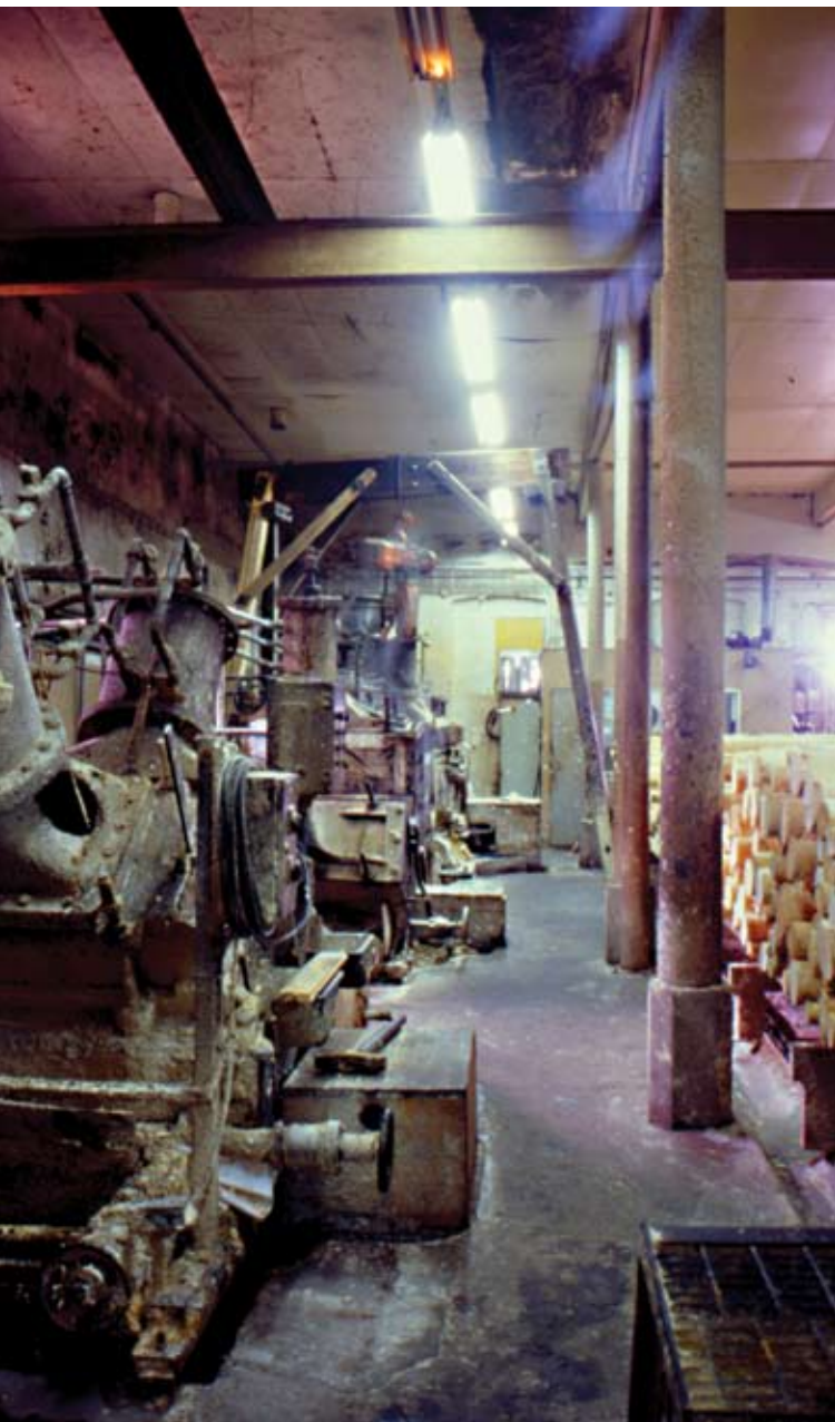
Kuva 18: Hiomakoneet sivulta nähtynä. Oikealla hiomakoneisiin ladattavia kuusipöllejä. Huoneen perällä pylväsrivin takana on kevytrakenteinen taukokoppi. Matti Huuhka 1998, Museokuva, MV.
