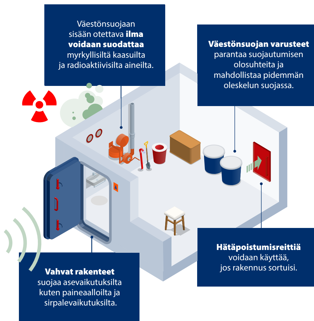
Kuva 3. Väestönsuojat antavat suojaa asevaikutuksilta ja rakennussortumilta sekä ionisoivalta säteilyltä ja myrkyllisiltä aineilta.
